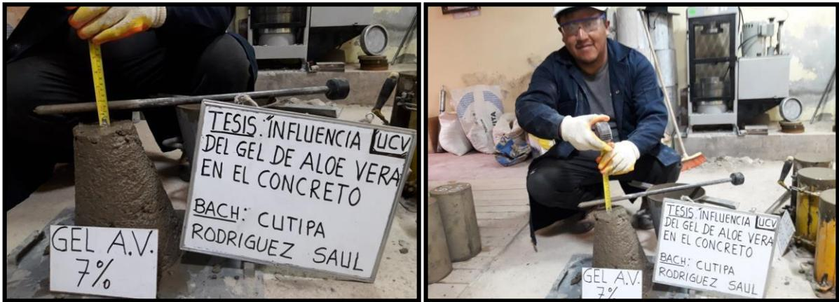
**Figura N° 14:** Ensayo de SLUMP (asentamiento) del concreto.
