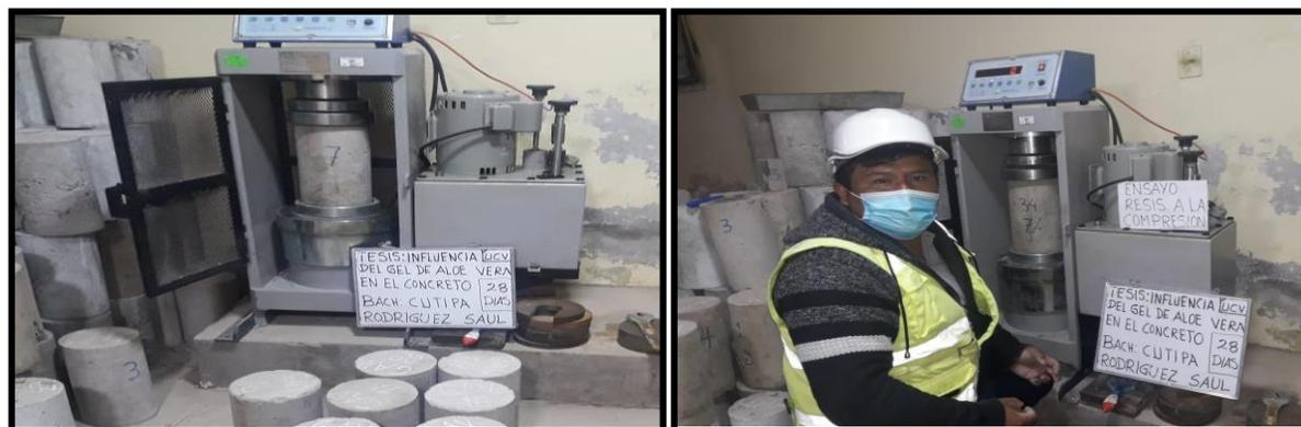
**Figura N° 20:** ensayo de resistencia a la compresión a los 28 días.
