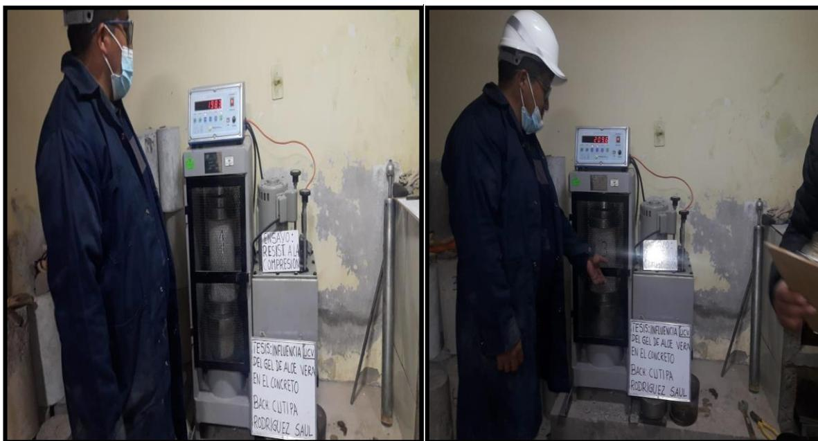
**Figura N° 16:** ensayo de resistencia a la compresión a los 7 días de edad.
