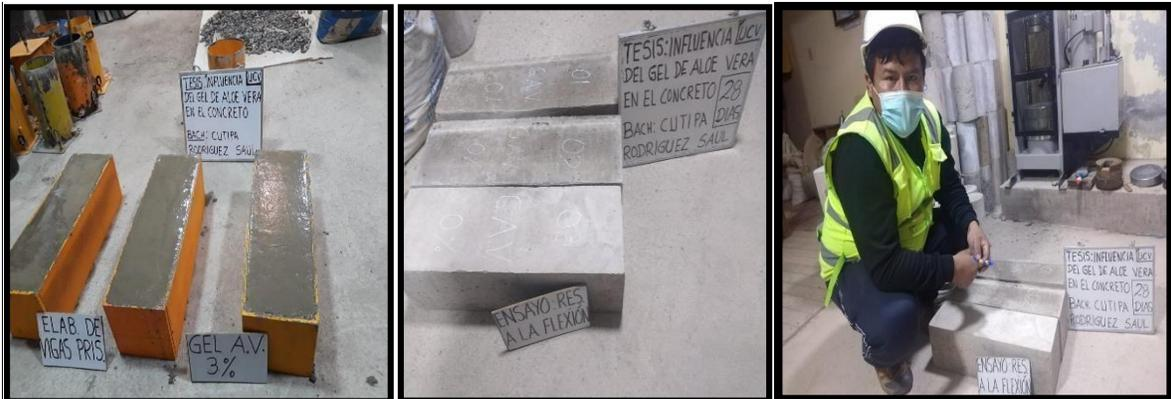
**Figura N° 22:** Especímenes ensayo de resistencia a la flexión.
