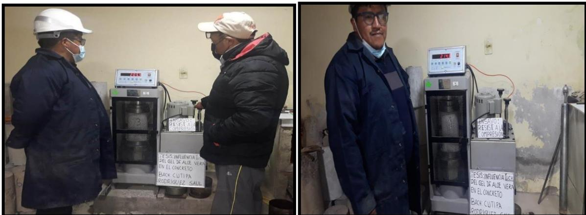
**Figura N° 24:** ensayo de resistencia a la compresión del concreto.
