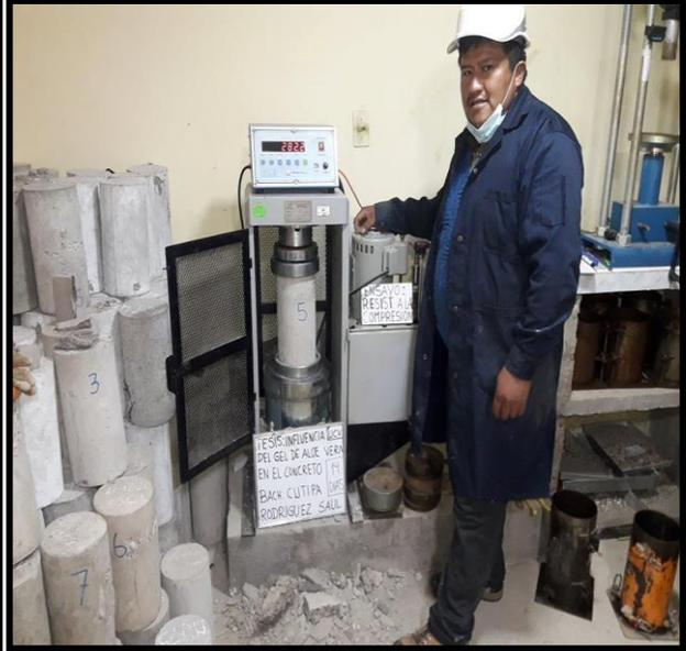
Ejecución de ensayos a compresión y flexión para determinar su resistencia.
