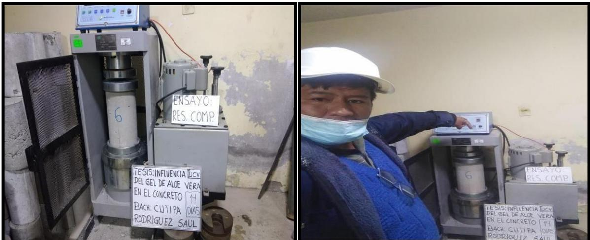
**Figura N° 18:** ensayo de resistencia a la compresión a los 14 días.
