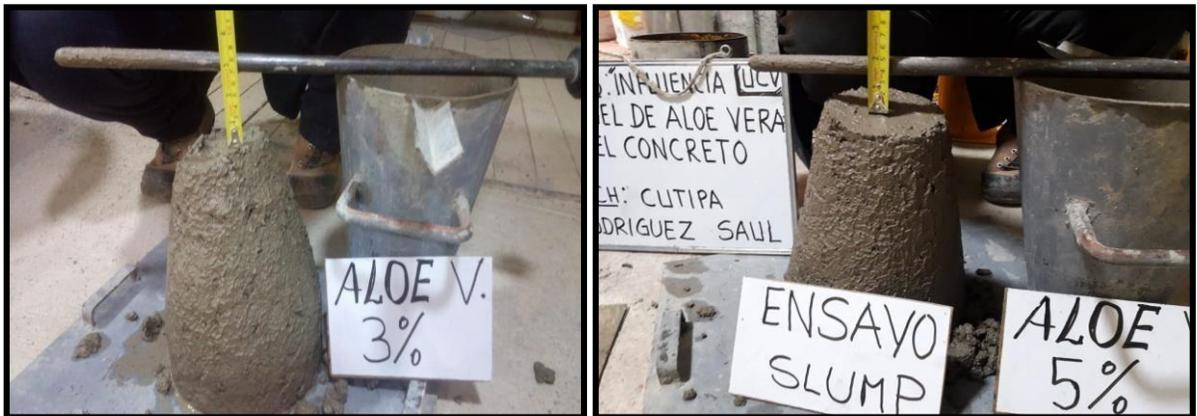
**Figura N° 28:** Ensayo de SLUMP (asentamiento) del concreto.
