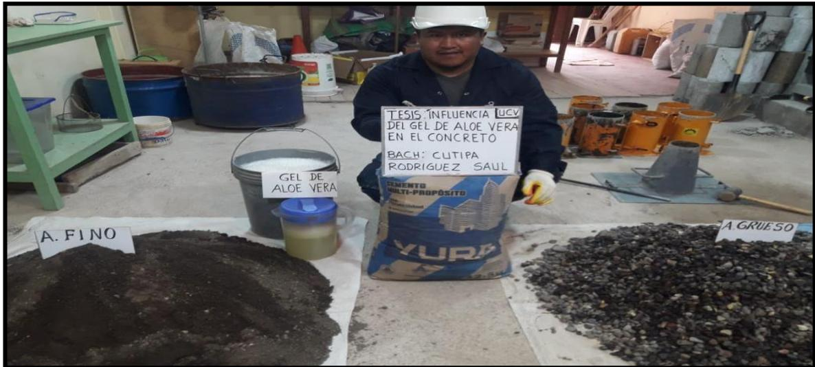
**Figura N° 07:** materiales para el concreto  $f'c=175 \text{ kg/cm}^2$
