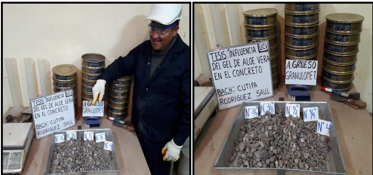
**Figura N° 10:** Realizando la granulometría del agregado grueso.
