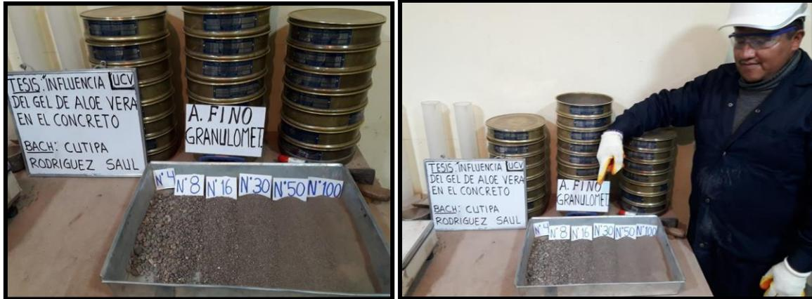
**Figura N° 12:** Ensayo granulometría del agregado fino.
