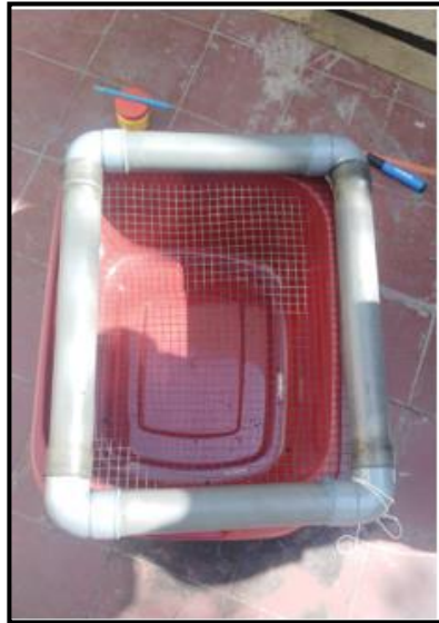
Figura 4: Cortado y colocación de malla galvanizada
