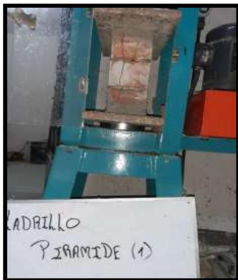
Figura 6. Falla ideal de las pilas de unidad de albañilería Pirámide
