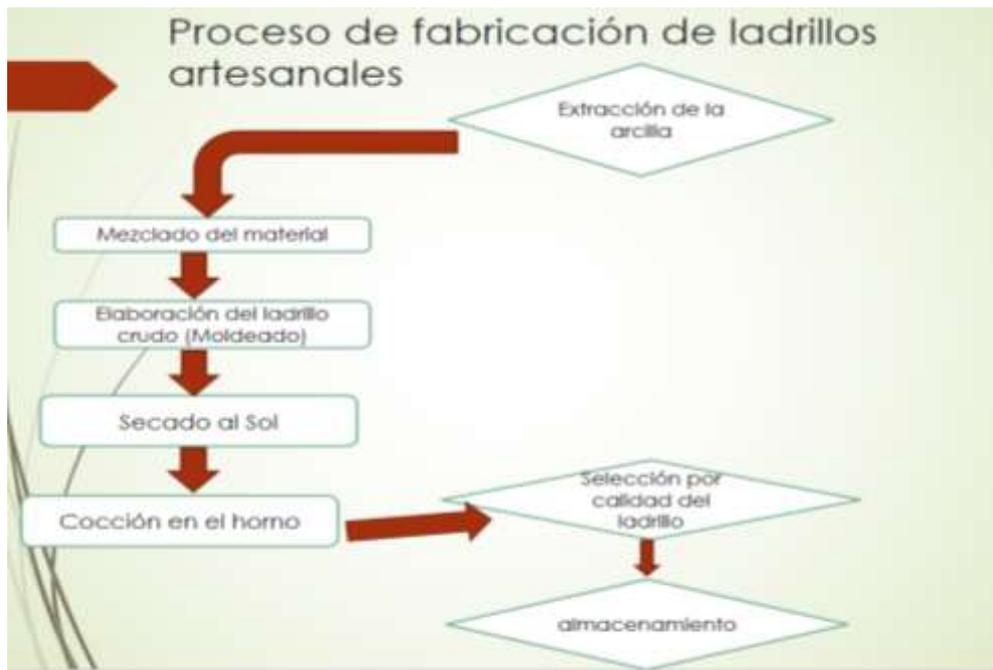
Figura 2. Proceso de elaboración del ladrillo artesanal
