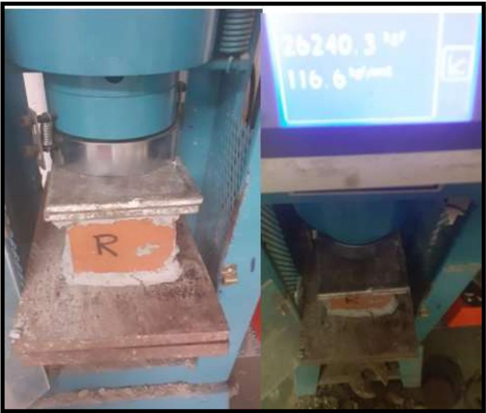
Ensayo de resistencia a la compresión Ladrillo Roy
