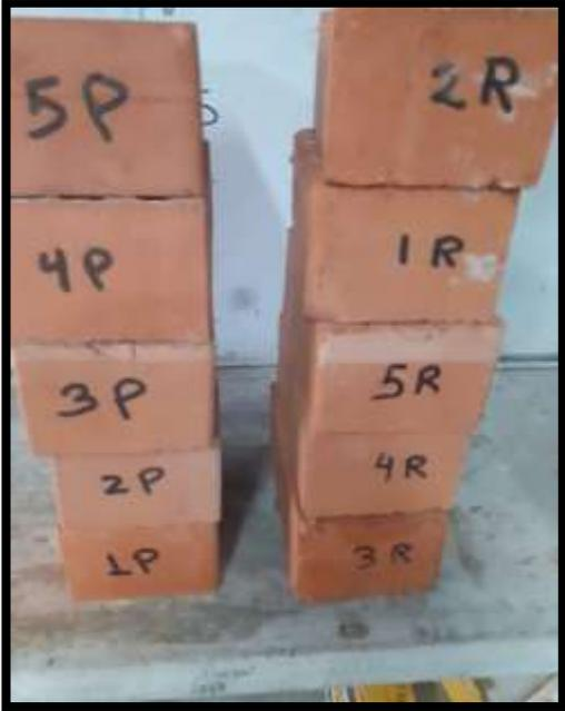
Rotulado de ladrillos para ensayo de resistencia a la compresión
