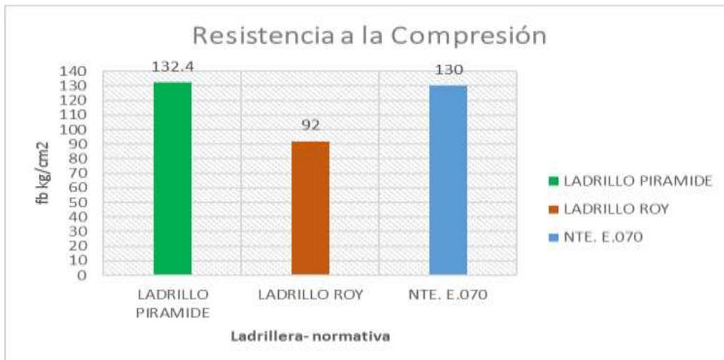
Figura 14. Cuadro comparativo de resistencia a la compresión
