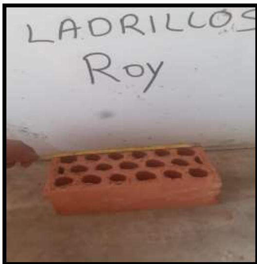
Figura 3. Medición de Variación Dimensional
