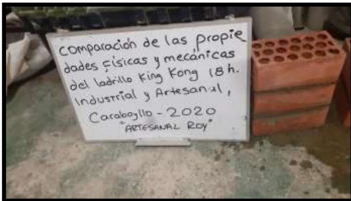
Muestras de Ladrillos Roy para Ensayos compresión axial por pilas
