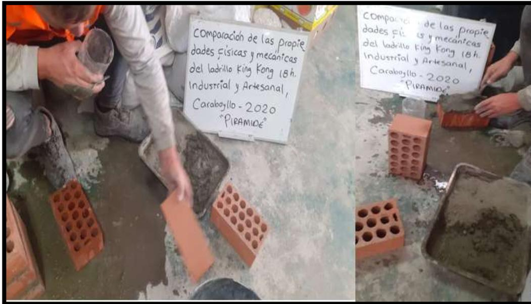
Elaboración de pilas para Ensayos de Compresión axial por Pilas
