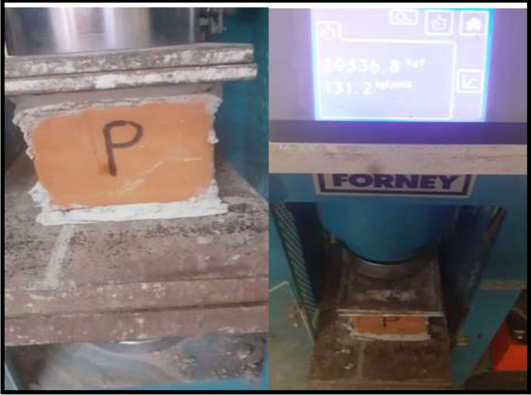
Ensayo de resistencia a la compresión Ladrillo Pirámide
