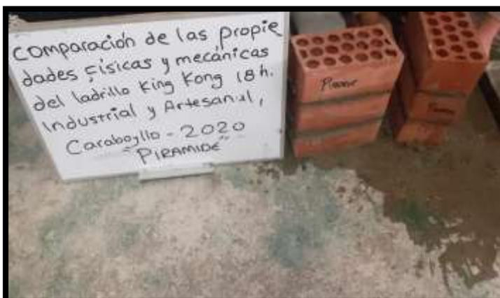
Muestras de Ladrillos Pirámide para Ensayos compresión axial por pilas
