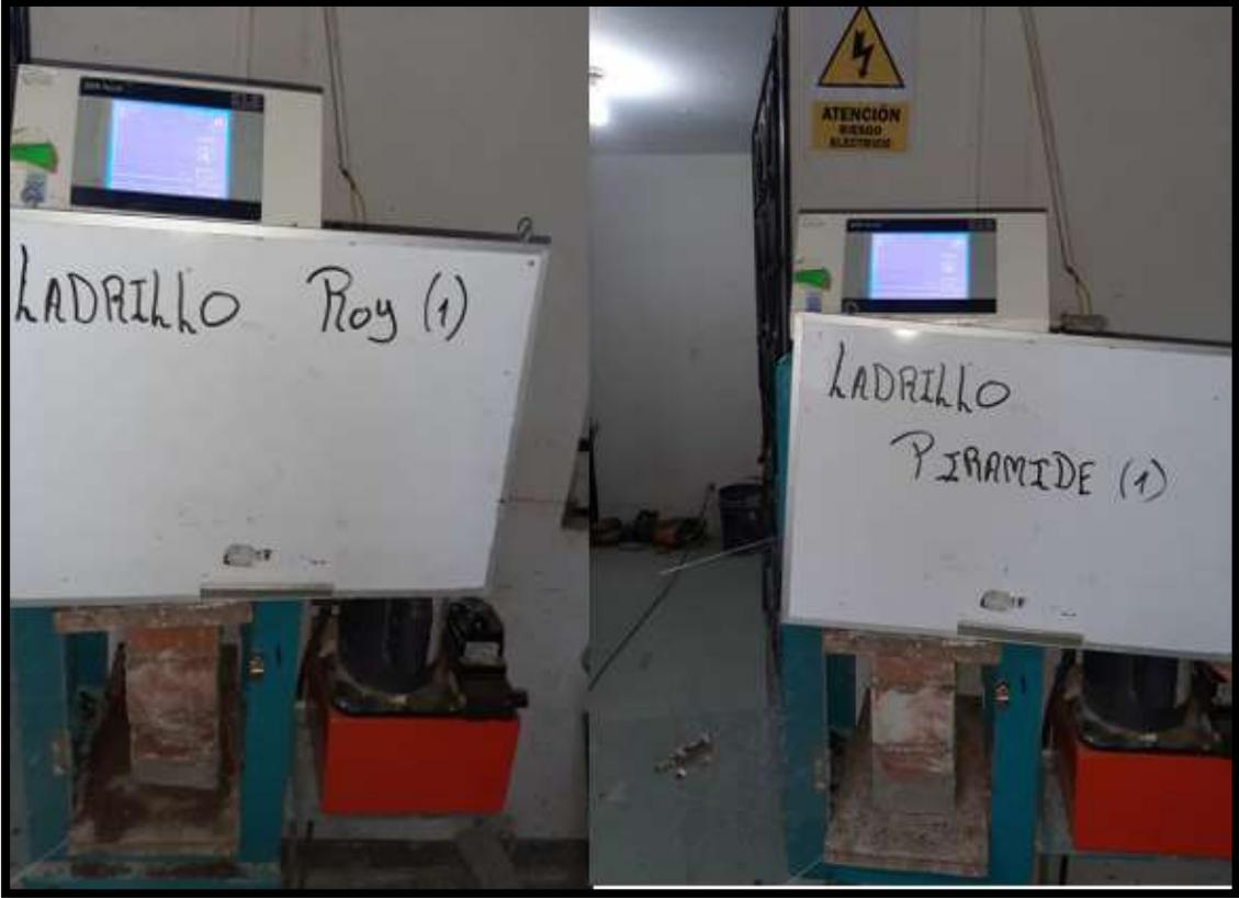
Ensayo de Compresión axial por pilas Ladrillo Pirámide y Roy
