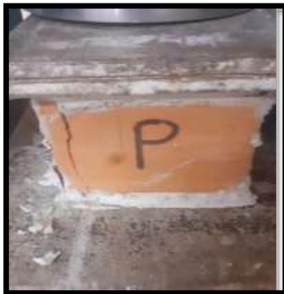
Figura 4. Ensayo de Resistencia a la Compresión por Unidad
