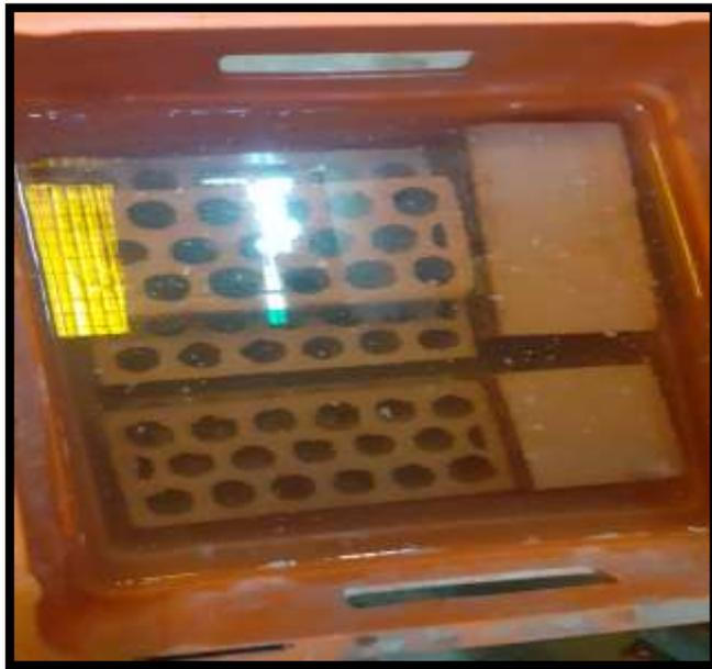
Figura 10. Colocación de los ladrillos para ensayo de Eflorescencia
