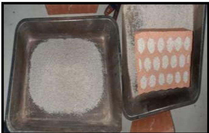
Preparación de la muestra para ensayo de porcentaje de vacíos
