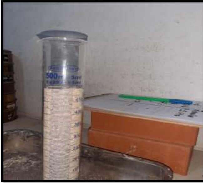
Figura 9. Probeta con arena para ensayo de Porcentajes de vacíos
