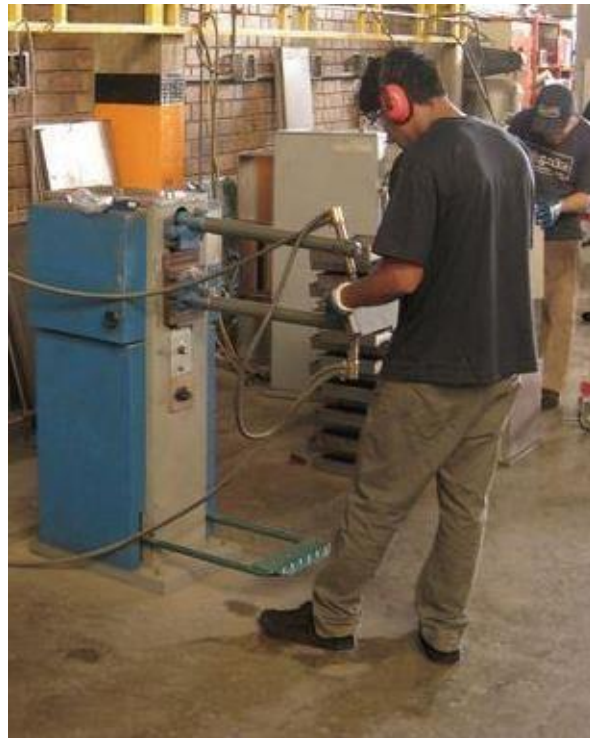
Figura 6 Soldadura de punto
