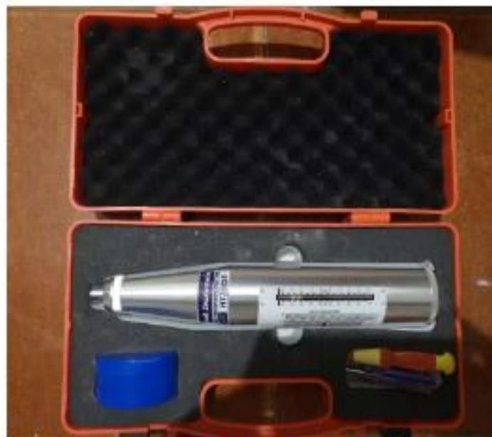
Figura 4. Esclerómetro empleado
