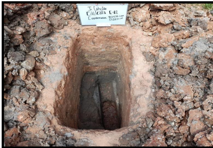
Se observa el perfil estratigráfico de la calicata
