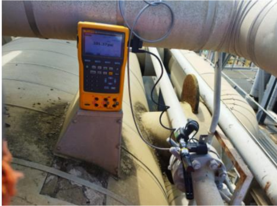
PIT (PRESIÓN INDICADOR TEMPERATURA) ARROJA 201.00 lo cual no necesita calibración y no es mucha diferencia a la foto.
