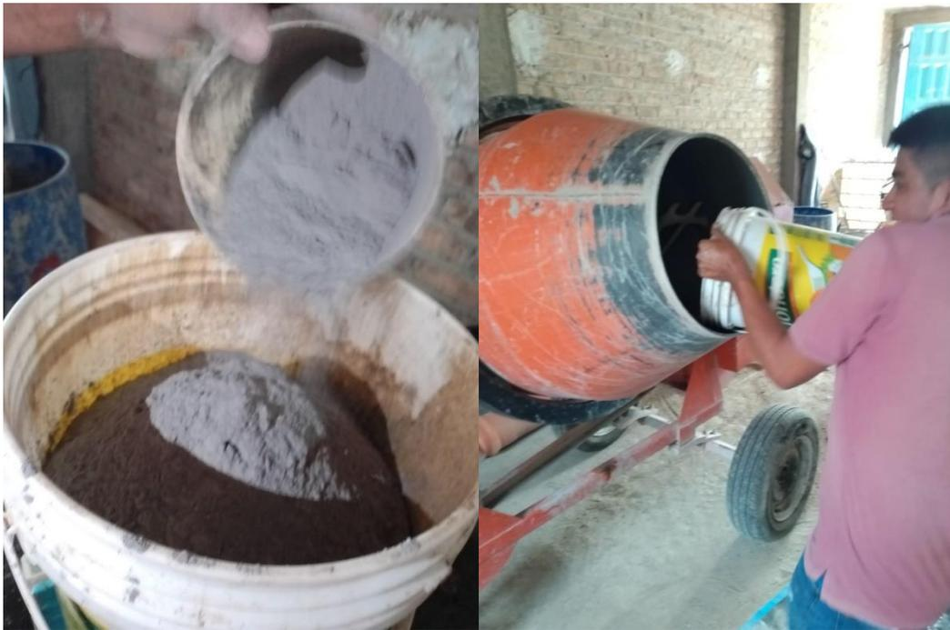
**Figura 9.** Pesado de materiales y preparación de la mezcla para la fabricación de ladrillos de concreto
