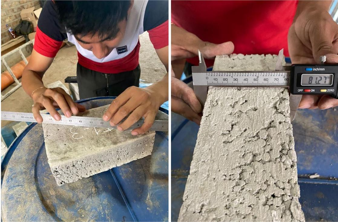
**Figura 11.** Medición de alabeos y variación dimensional de los ladrillos de concreto
