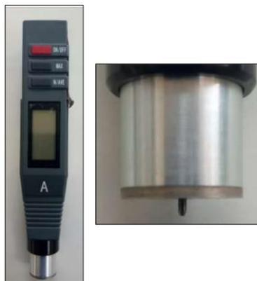
**Figura N° 36:** Análisis de dureza Shore A de los bioplásticos.
