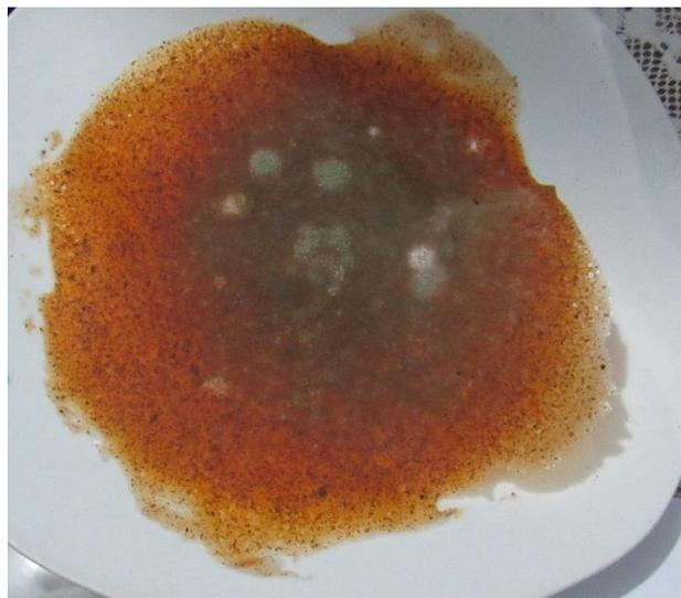
**Figura N° 34:** Bioplástico con presencia de hongos durante el secado.
