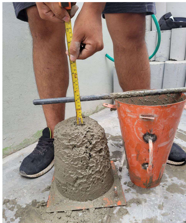
Figura 2. Medición del Slump
