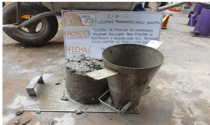
Figura 8. Ensayo con el cono de Abrams.
