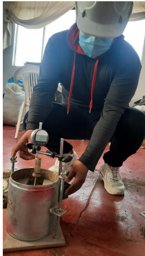
Fotografía N° 5 y 6. Ensayo EMS: Proctor Modificado.
