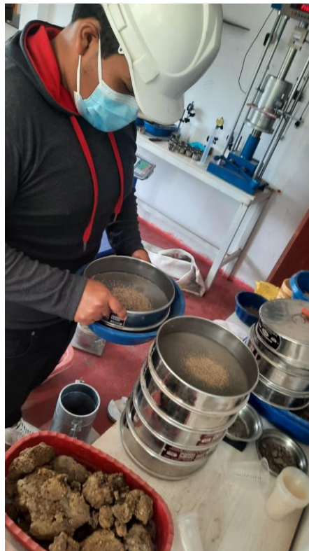
Fotografía N° 3 y 4. Ensayo EMS: Análisis Granulométrico.
