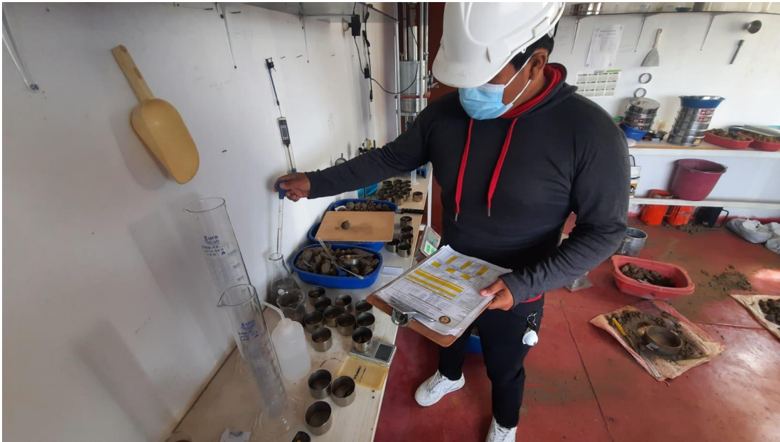
Fotografía N° 8. Ensayo EMS: Contenido de Humedad.
