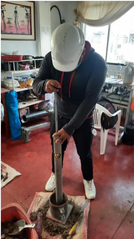
Fotografía N° 5 y 6. Ensayo EMS: Proctor Modificado.
