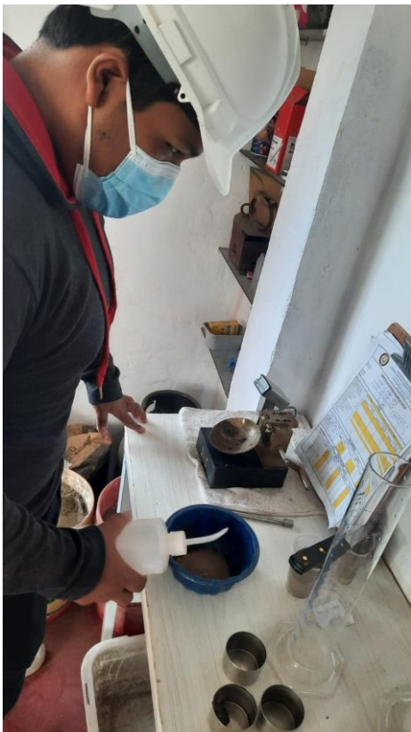
Fotografía N° 7 y 8. Ensayo EMS: Límites de Atterberg.
