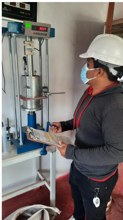
Fotografía N° 9. Ensayo EMS: CBR.
