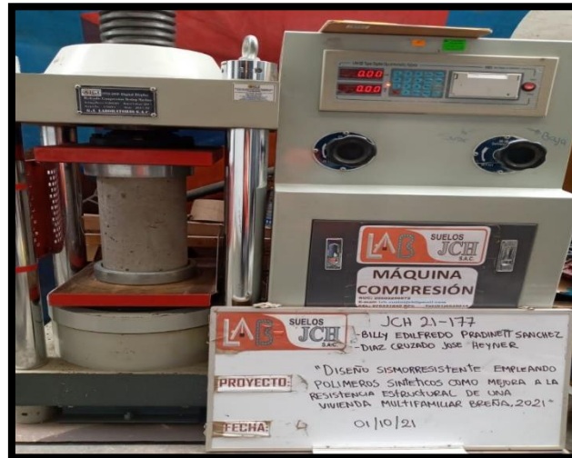
Figura 17. Ensayo de rotura de probetas - Diseño Patrón.
