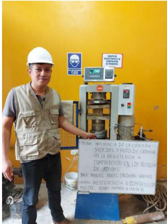
FOTOGRAFIA 01: Ensayo a compresión de testigos de concreto bajo la norma ASTM C39 de la muestra de concreto del Proyecto de tesis: "Influencia De La Cáscara Seca Del Fruto De Catahua En La Resistencia A Compresión En Bloques De Adobe, Jaén, 2021".
