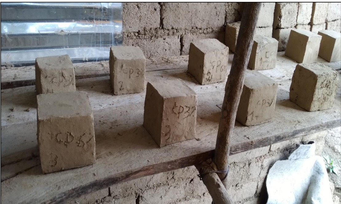
IMAGEN 17. Se indica las muestras del bloque de adobe patrón y las muestras con adición de cáscara seca del fruto de catahua.
