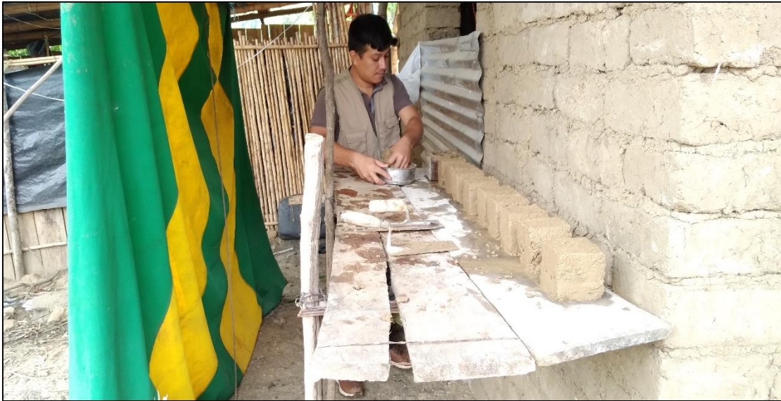
IMAGEN 17. Se indica las muestras del bloque de adobe patrón y las muestras con adición de cáscara seca del fruto de catahua.
