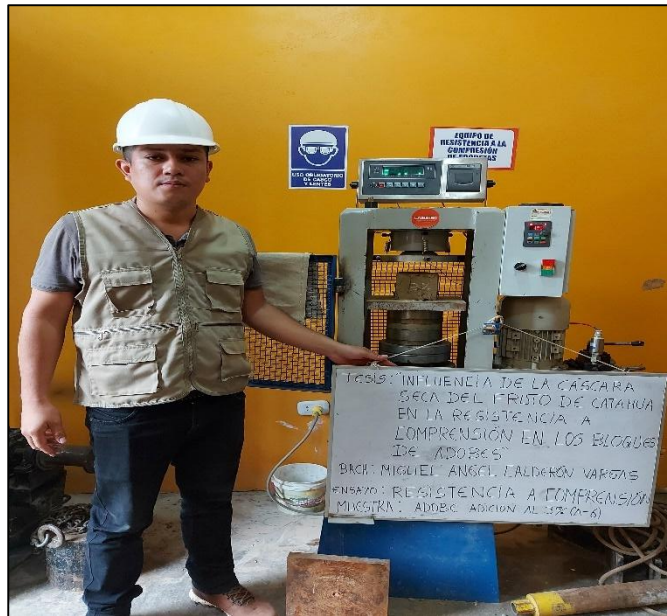
IMAGEN 20. Se realiza el ensayo a compresión de las muestras al 3% de cáscara seca del fruto de catahua.
