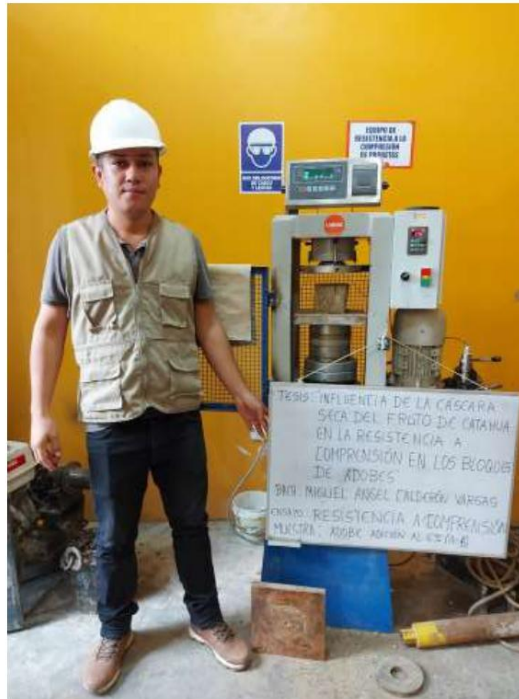
FOTOGRAFIA 05: Ensayo a compresión de testigos de concreto bajo la norma ASTM C39 de la muestra de concreto del Proyecto de tesis: "Influencia De La Cáscara Seca Del Fruto De Cathua En La Resistencia A Compresión En Bloques De Adobe, Jaén, 2021".
