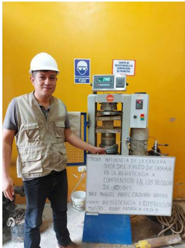
FOTOGRAFIA 02: Ensayo a compresión de testigos de concreto bajo la norma ASTM C39 de la muestra de concreto del Proyecto de tesis: "Influencia De La Cáscara Seca Del Fruto De Catahua En La Resistencia A Compresión En Bloques De Adobe, Jaén, 2021".
