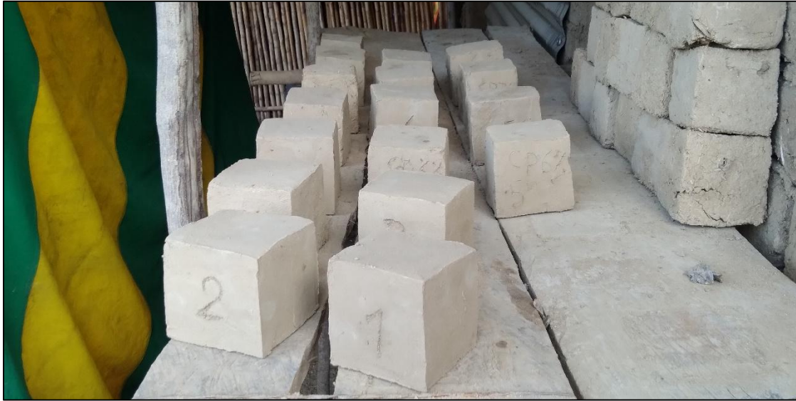
IMAGEN 18. Una vez seco el bloque de adobe después de 28 días se lleva al laboratorio labsuc para realizar el ensayo de resistencia a compresión.
