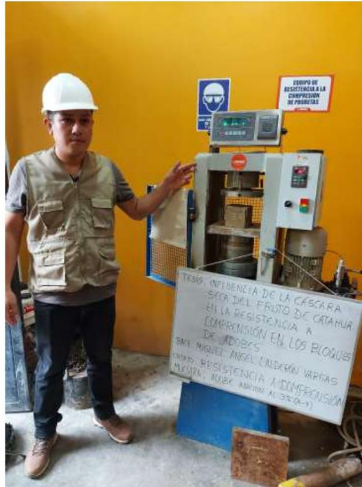
FOTOGRAFIA 04: Ensayo a compresión de testigos de concreto bajo la norma ASTM C39 de la muestra de concreto del Proyecto de tesis: "Influencia De La Cáscara Seca Del Fruto De Catahua En La Resistencia A Compresión En Bloques De Adobe, Jaén, 2021".
