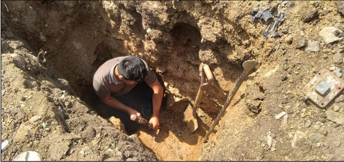
IMAGEN 04. Extracción de la muestra de arcilla de una calicata de 1.5 metros de profundidad.
