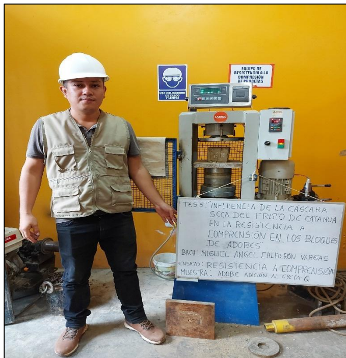
IMAGEN 21. Se realiza el ensayo a compresión de la muestra al 6% de cascara seca del fruto de catahua.
