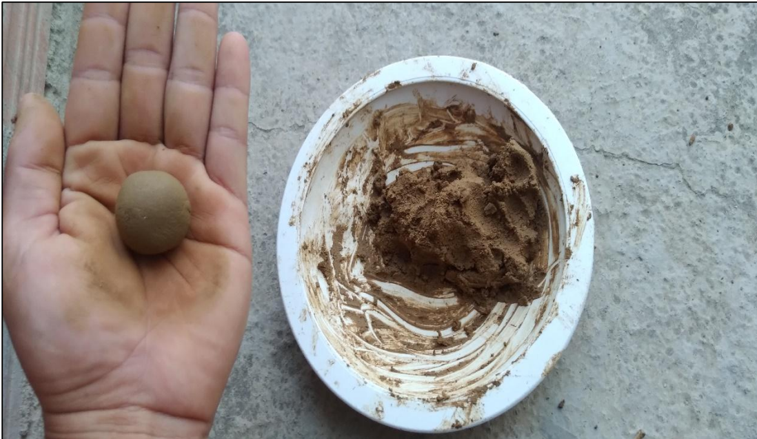
IMAGEN 05. Se hace la prueba rápida de Resistencia seca para el descarte de arcilla según la norma E.080.
