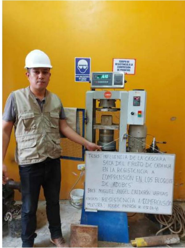
FOTOGRAFIA 03: Ensayo a compresión de testigos de concreto bajo la norma ASTM C39 de la muestra de concreto del Proyecto de tesis: "Influencia De La Cáscara Seca Del Fruto De Catahua En La Resistencia A Compresión En Bloques De Adobe, Jaén, 2021".
