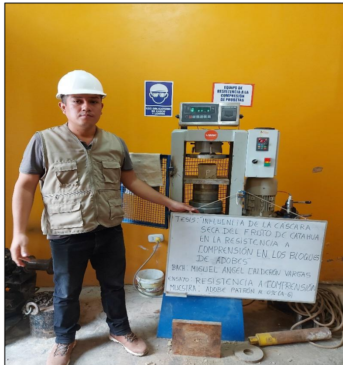
IMAGEN 19. Se realiza el ensayo a compresión del bloque de adobe patrón.
