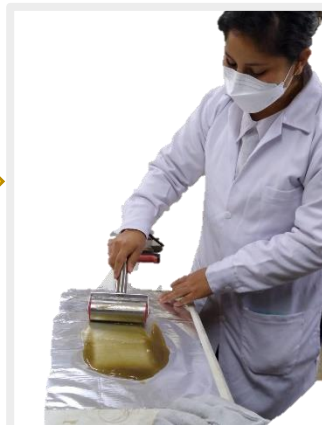
Vertimiento de la mezcla al aluminio
