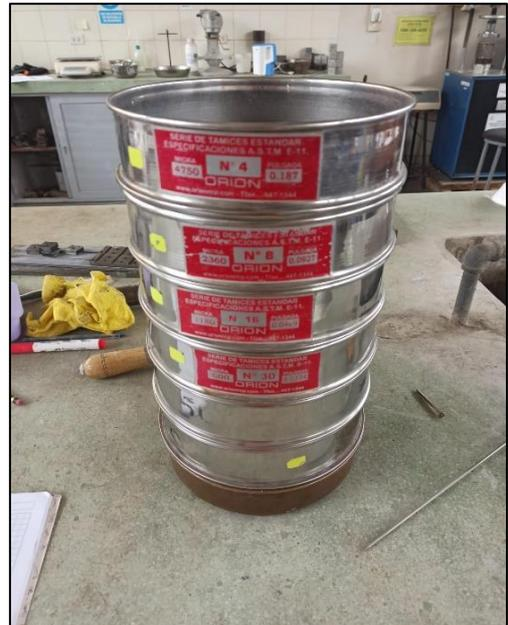
Imagen: Mallas para el tamizado de la arena
