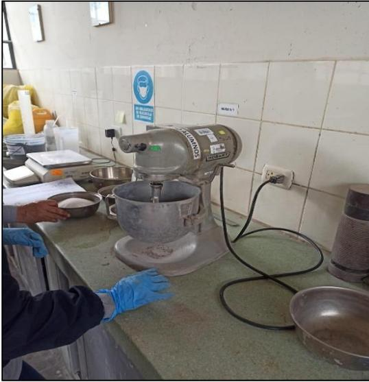
*Imagen:* Preparación mezcla para ensayo a compresión
