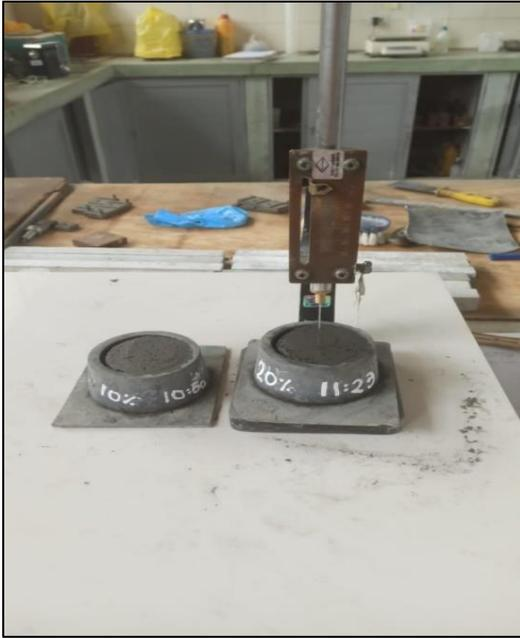
Imagen: Penetración para muestras con 10% y 20% CCY
