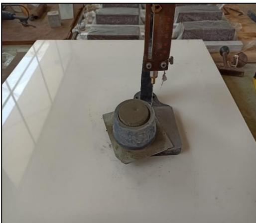
*Imagen:* Penetración del vástago
