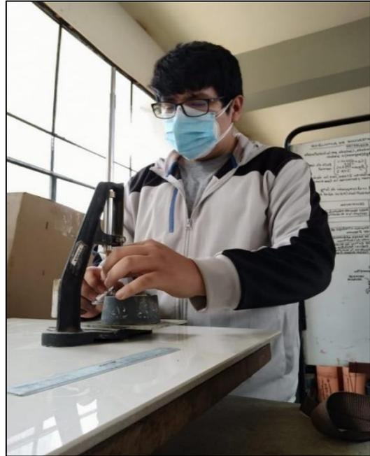
*Imagen:* Ensayo tiempo de fraguado
