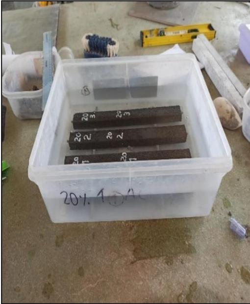
*Imagen:* Barras de mortero sumergidas en agua.
