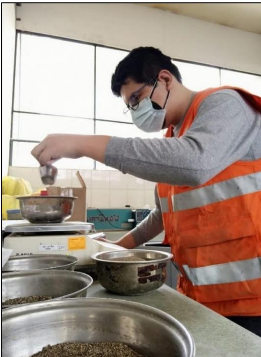
*Imagen:* Pesado de la ceniza para en ensayo de reactividad álcali
