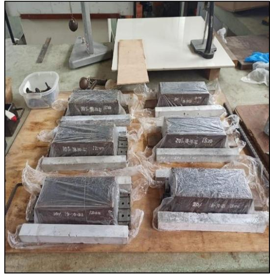
*Imagen:* Especímenes de mortero con 10% y 20% CCY
