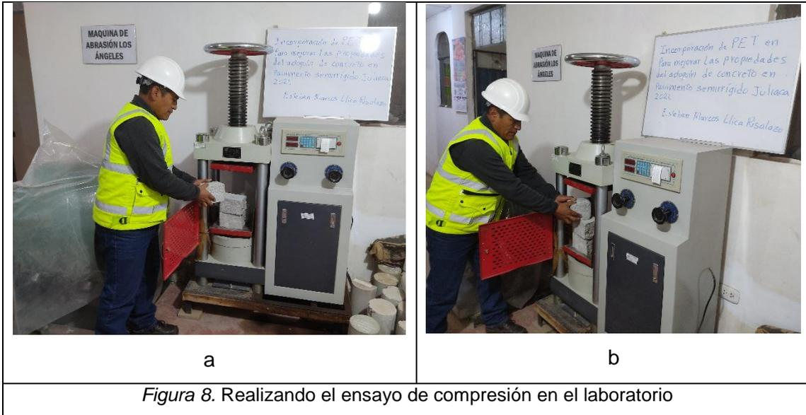
Figura 8. Realizando el ensayo de compresión en el laboratorio
