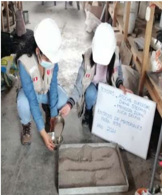
Foto 7. Cuarteo de muestra del suelo arena la graduada, de nula plasticidad.
