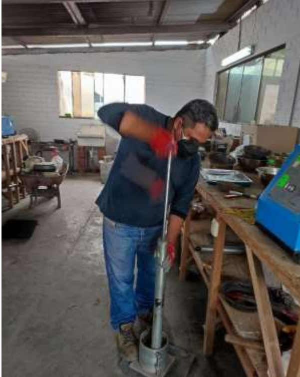
Figura 12. Compactación del suelo mediante el martillo manual para el ensayo de Proctor modificado NTP 339.141.
