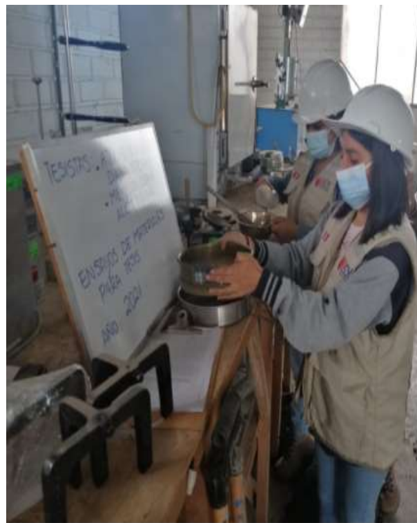
Figura 19. Colocación de la muestra en una vasija de evaporación y añadir una pequeña gota de agua
