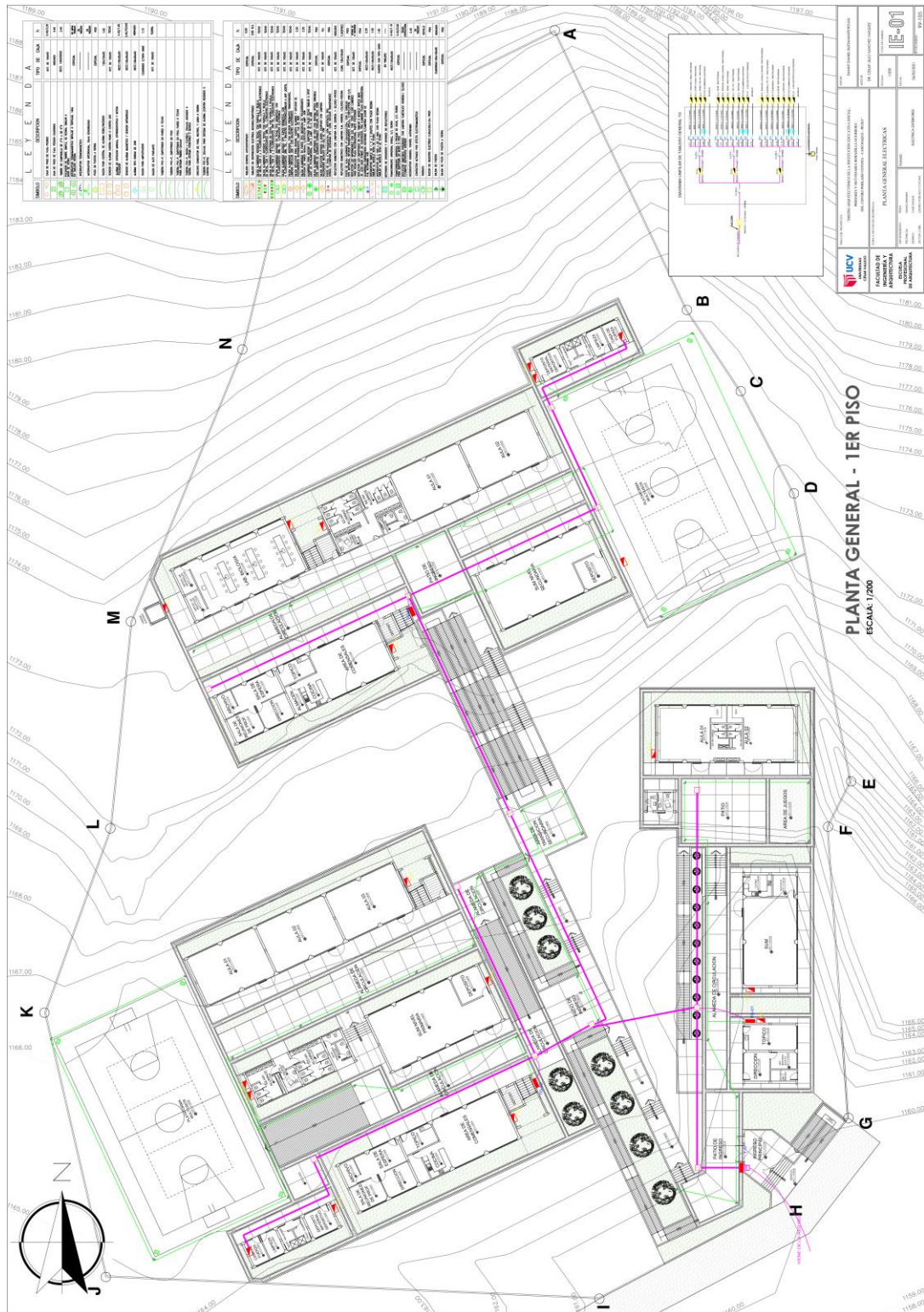
IMAGEN N°118: PLANO INSTALACIÓN ELÉCTRICA EXTERIOR
