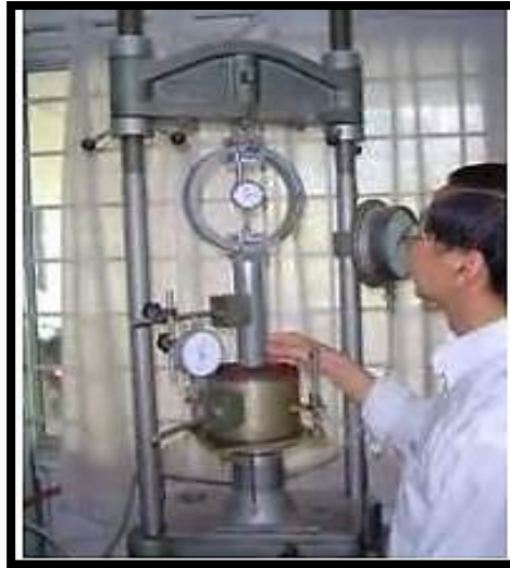
Figura 4. Ensayo CBR en laboratorio
