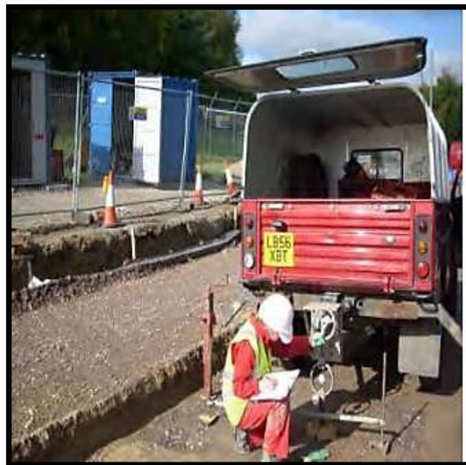
Figura 5. Ensayo del CBR en campo
