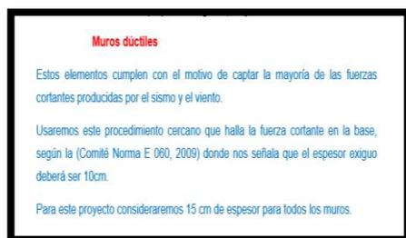
Figura 12: muros dúctiles
