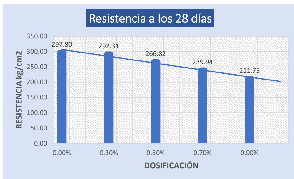
Figura N°50: Gráfica de Resistencia promedio a compresión a los 28 días
