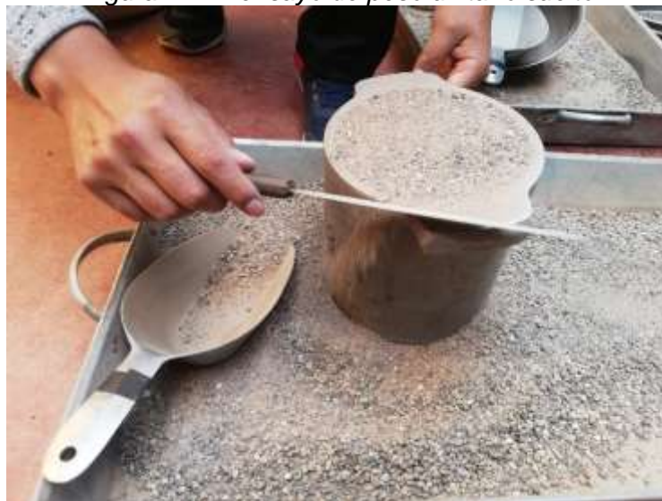
Figura N°27: ensayo de peso unitario suelto
