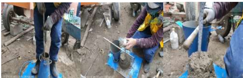
Figura N°39: ensayo de Consistencia
