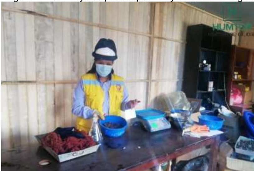
Figura N°25: ensayo de peso específico y absorción de agua
