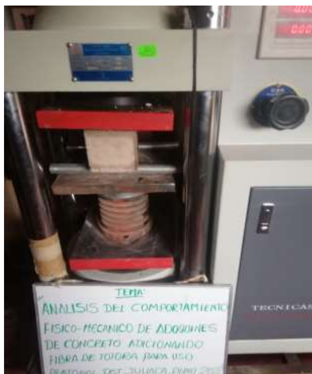
Figura N°53: Ensayo de rotura a la flexión
