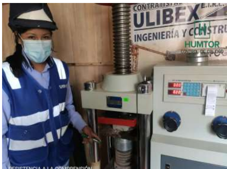
Figura N°44: Rotura a compresión a 7 días
