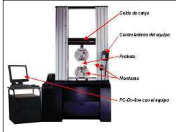
Figura 17: Equipo para resistencia a tracción
