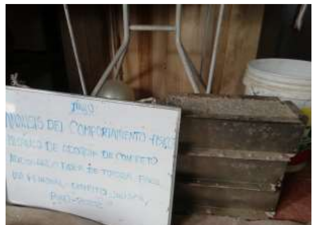
Fotografía 16: muestras de vigas elaboradas para el concreto patrón.
