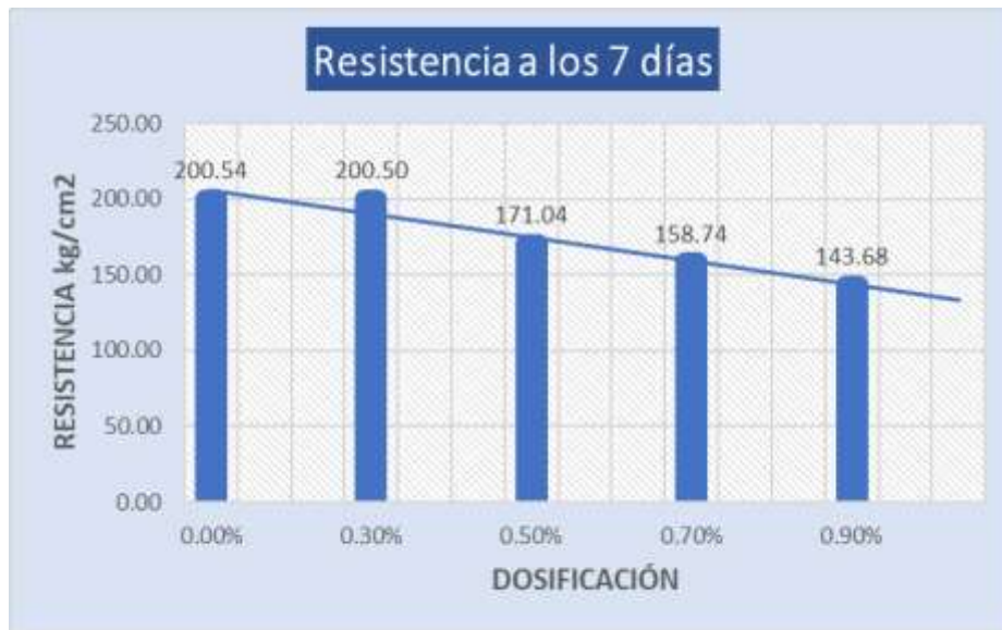
Figura N°45: Gráfica de resistencia promedio a compresión a los 7 días
