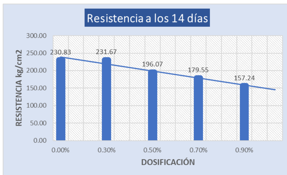
Figura N°47: Gráfica de Resistencia promedio a compresión a los 14 días
