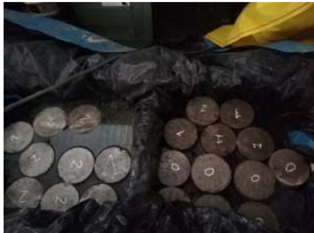
Fotografía 19: curado de adoquines y briquetas cilíndricas.
