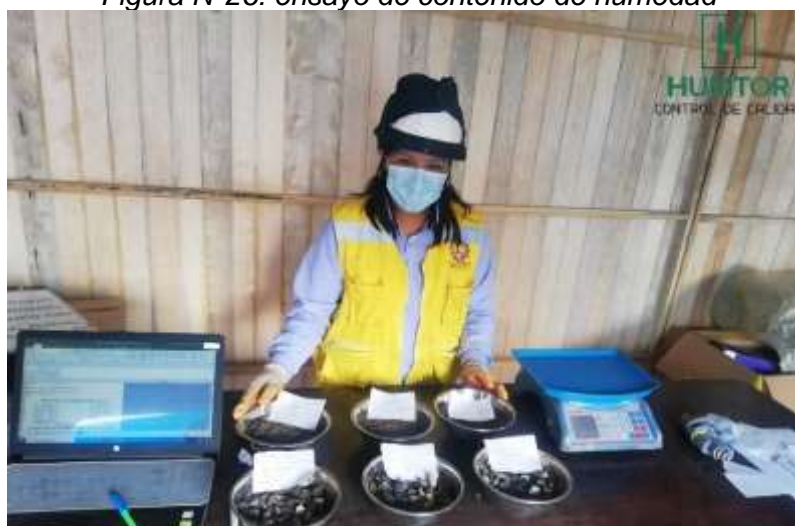
Figura N°26: ensayo de contenido de humedad
