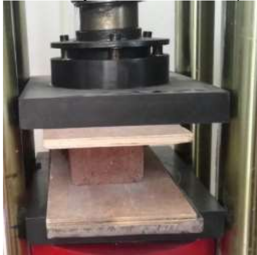
Figura 15: Ensayo de resistencia a compresión
