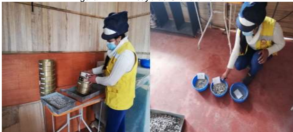
Figura N°24: Ensayo de Granulometría
