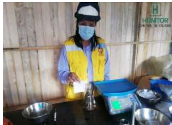
Fotografía 04: Ensayo de peso específico y absorción de agua por el método del picnómetro
