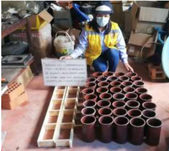
Fotografía 11: Moldes para la elaboración de adoquines y briquetas cilíndricas
