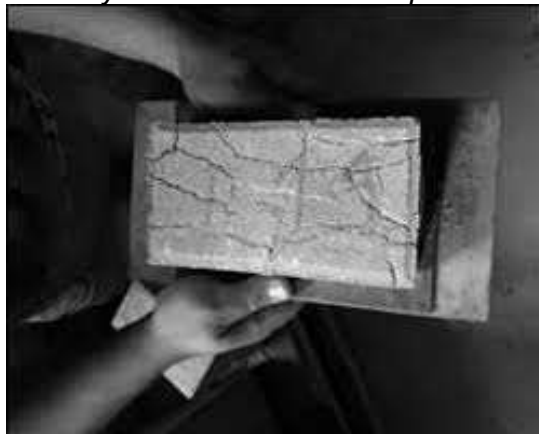
Figura 12: Ensayo de resistencia a compresión de adoquín
