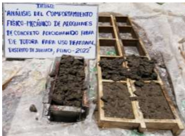
Fotografía 15: proceso de elaboración de adoquines y viga.
