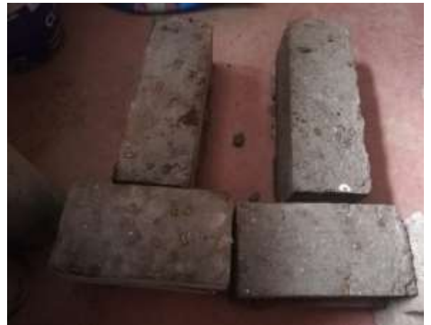
Fotografía 18: Desmoldeo de viga para determinar resistencia a la flexión.
