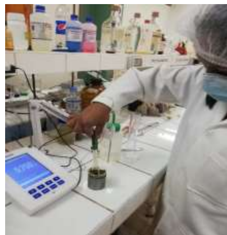
Fotografía 10: Determinación de PH de la fibra de totora.
