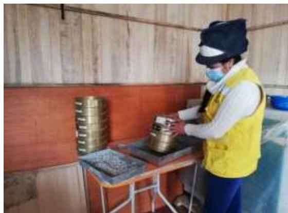
Fotografía 03: Ensayo de Análisis granulométrico de AG y AF
