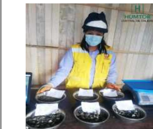
Fotografía 05: Ensayo de contenido de humedad de AG y AF
