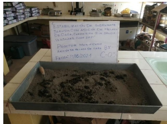
Figura 9.3 Proctor modificado para determinar la máxima densidad seca con adición del 8% melaza de caña C-03
