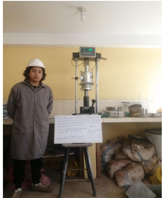
Figura 9.7 Ensayo California Bearing Ratio para determinar su resistencia potencial con adición de 3% melaza de caña C-03
