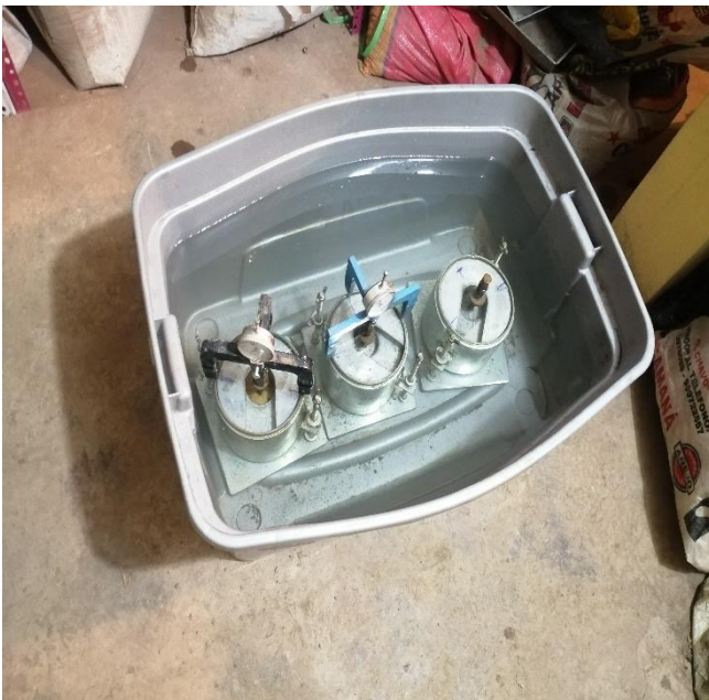
Figura 9.8 Muestras sumergidas, ensayo California Bearing Ratio para determinar su resistencia potencial con adición de 8% melaza de caña C-01
