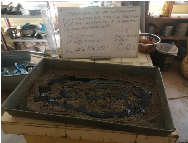
Figura 9.1 Proctor modificado para determinar la máxima densidad seca con adición del 8% melaza de caña C-03
