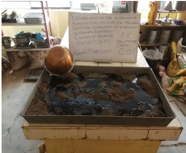
Figura 9.6 Ensayo California Bearing Ratio para determinar su resistencia potencial con adición de 8% melaza de caña C-01
