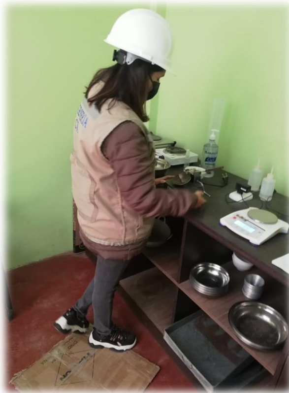
FOTO N°8; HALLAMOS LOS LIMITES DE CONSISTENCIA.
