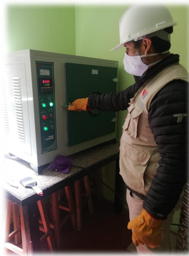
FOTO N°4: PUESTA DEL MATERIAL AL HORNO.
