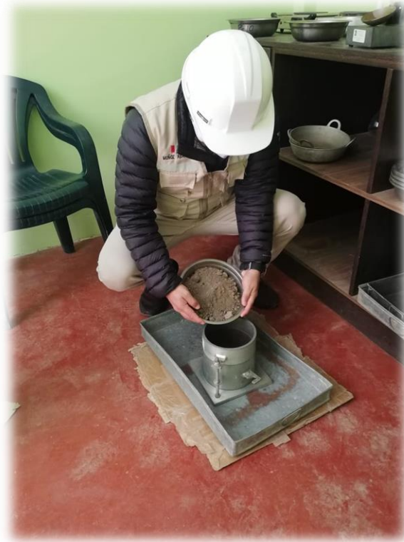
FOTO N°9: VACIAMOS LA MUESTRA DEL MATERIAL AL MOLDE DE PROCTOR.
