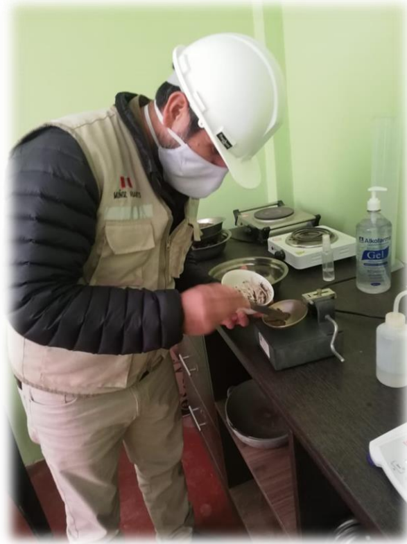
FOTO N°7: HALLAMOS LOS LIMITES DE CONSISTENCIA.
