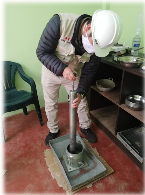
FOTO N°: DAMOS GOLPES CON EL MARTILLO PARA HALLAR EL PROCTOR.
