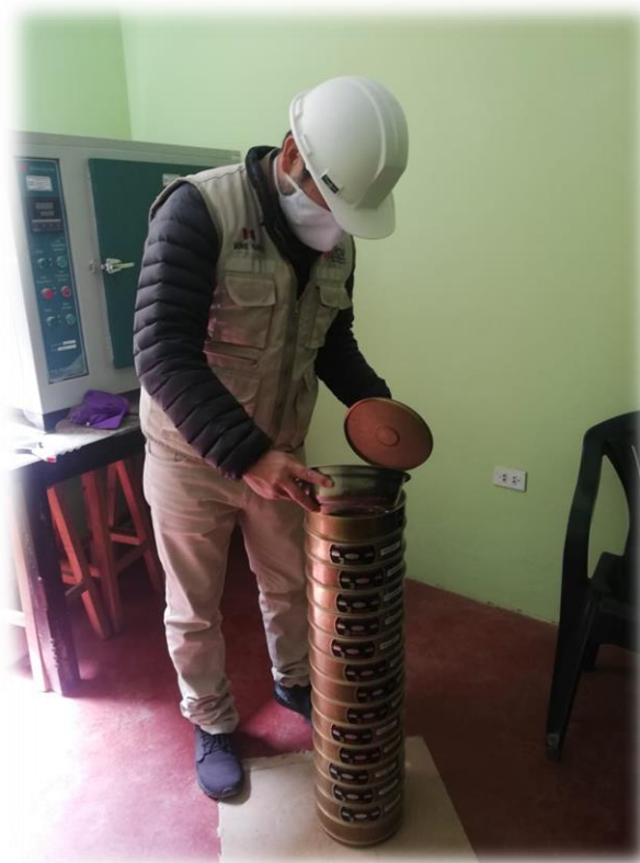
FOTO N°6: PASAMOS LA MUESTRA POR LOS TAMICES, PARA VER SU GRANULOMETRIA.
