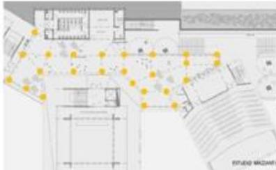
La estructura aporticada de concreto que soporta a todo el volumen interno que se dilata de la piel para permitir el ingreso de luz.
