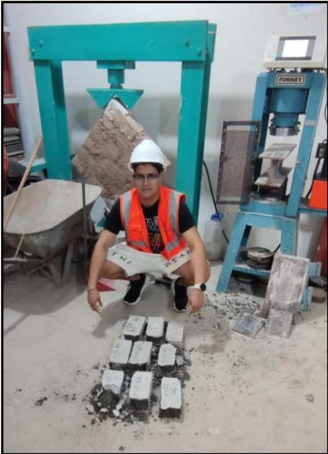
Figura N° 41: Adoquines ensayados a compresión por la maquina hidráulica
