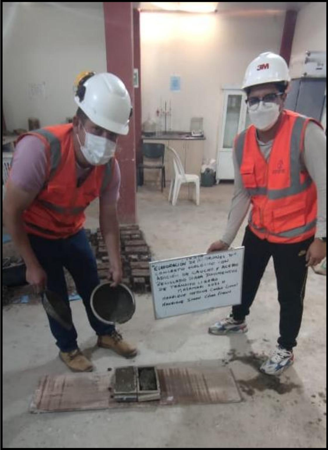
Figura N° 40: Ensayo de rotura de compresión de los adoquines
