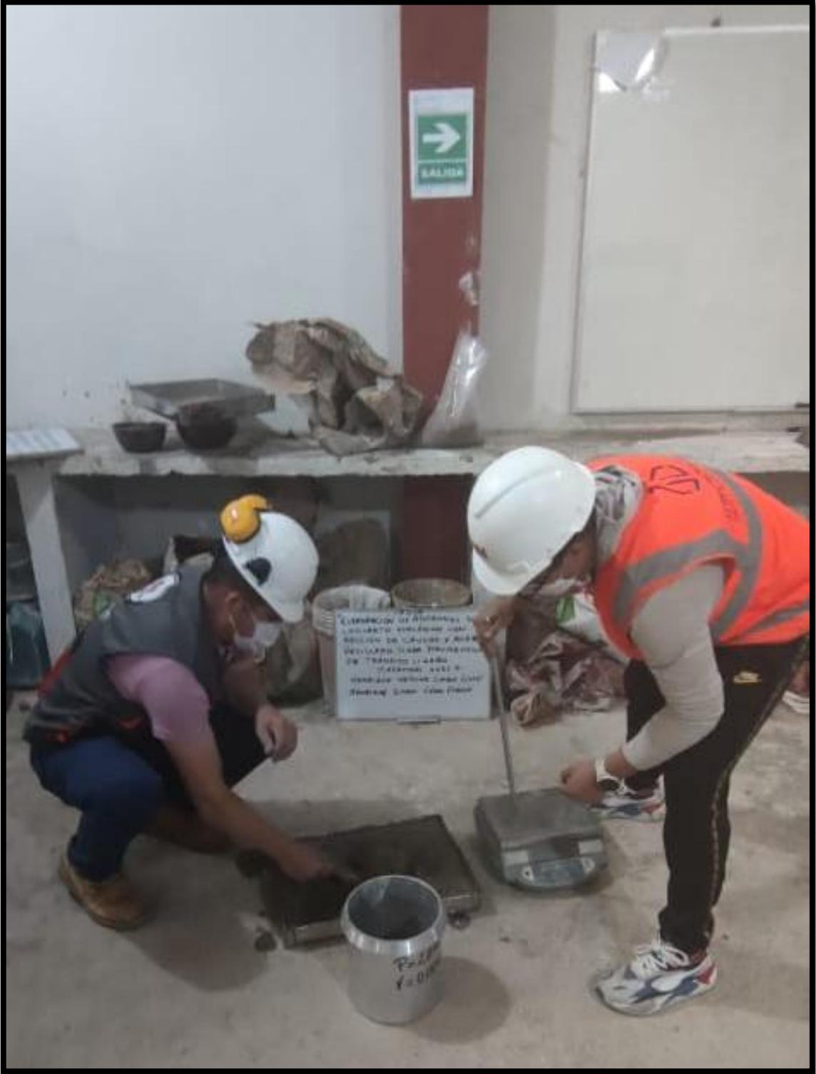
Figura N° 38: Peso unitario del concreto
