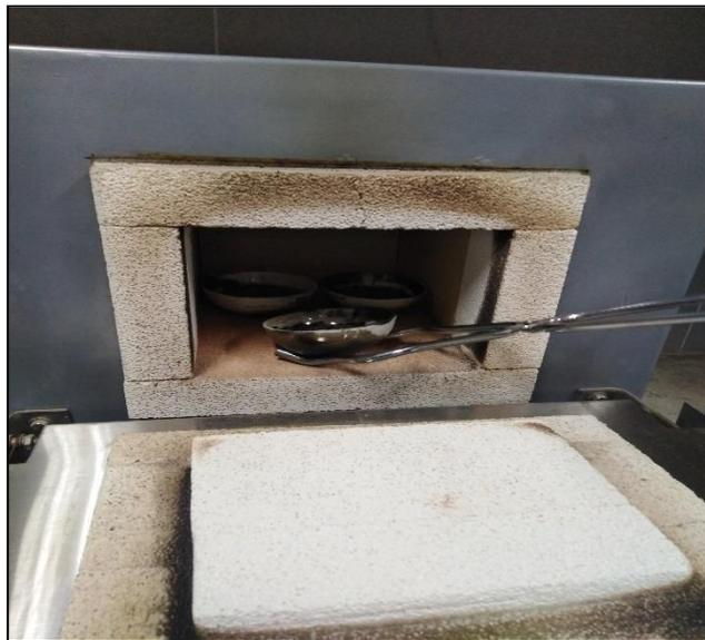
**Figura 11. Permanencia en mufla a 600°C por 2 horas.**
