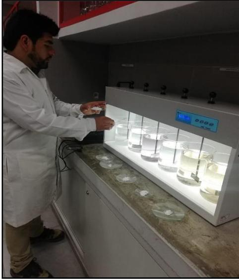
*Figura 38. Prueba de jarras con dosis Floculante uva.*
