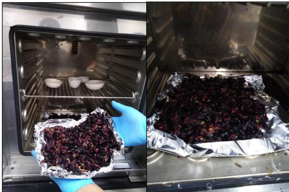
**Figura 7. Proceso de secado en estufa a 60°C por 48 horas.**
