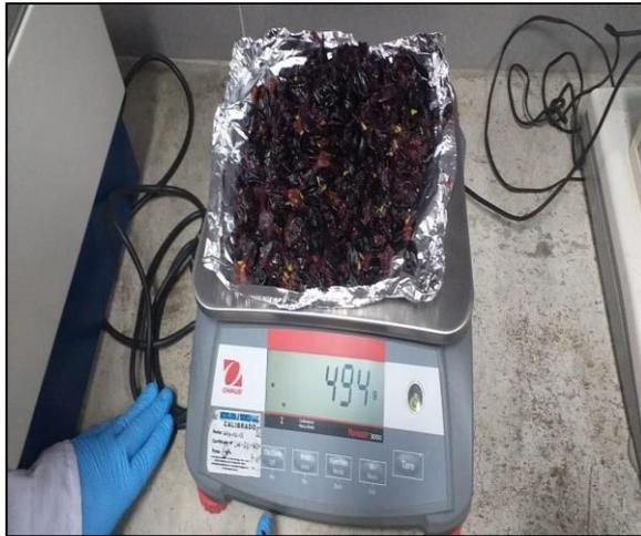
Figura 8. Obtención de peso seco del hollejo de uva
