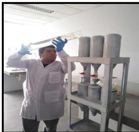
**Figura 13. Sistema de tratamiento de agua contaminada.**
