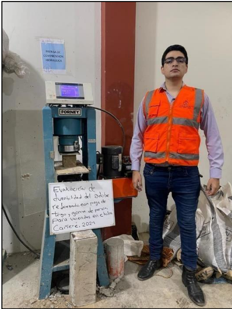
Figura 13: Ensayo a compresión Fuente: Elaboración propia
