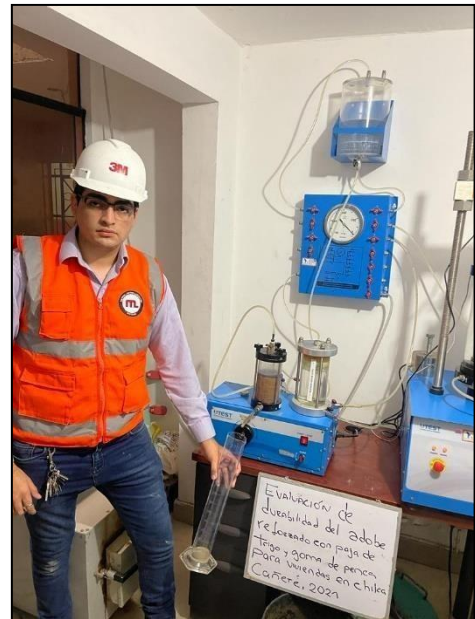
Figura 12. Prueba de permeabilidad Fuente: Elaboración propia
