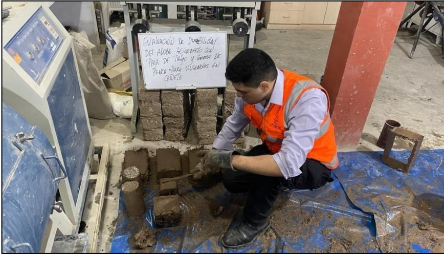
Figura 14: Elaboración de los adobes Fuente: Elaboración propia
