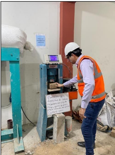
Figura 13: Ensayo a flexión Fuente: Elaboración propia
