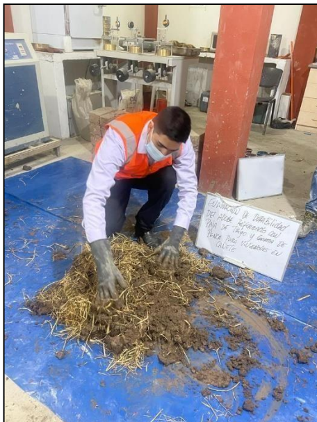
Figura 11. Preparación y mezclado de la tierra con los agregados Fuente: Elaboración propia
