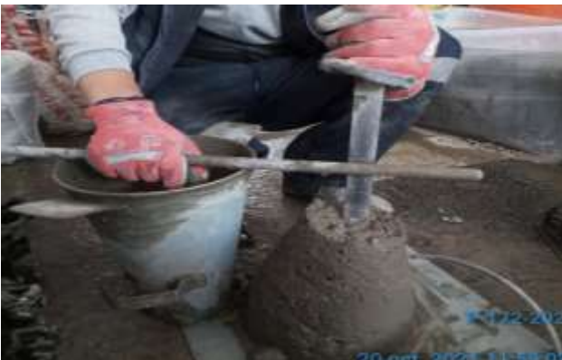
Figura 8: Ensayo de asentamiento.
