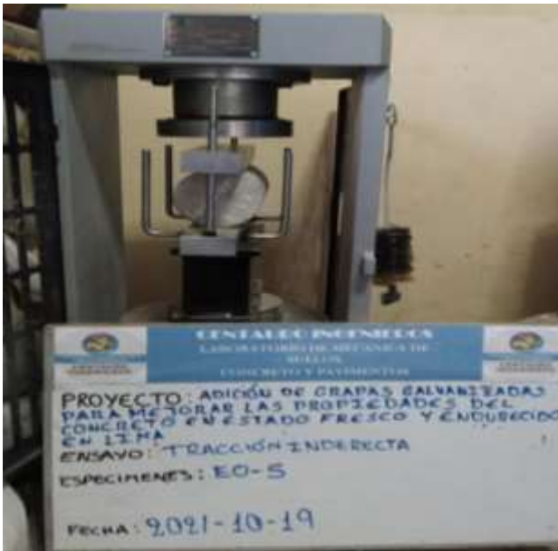
Figura 9: Ensayo de tracción indirecta
