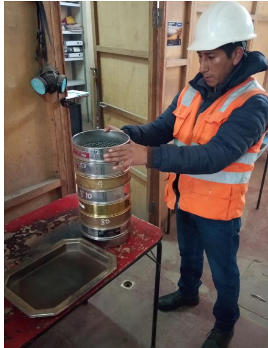
Figura 16. Determinación de la Granulometría
