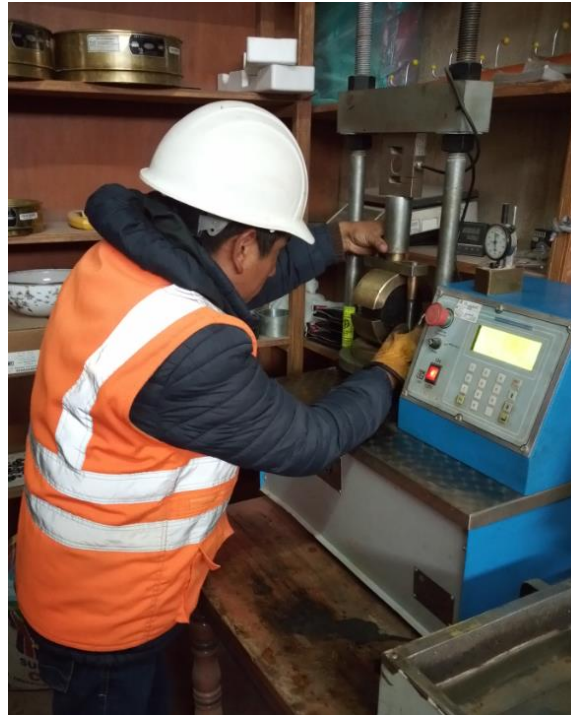
Figura 24. Rotura de briquetas
