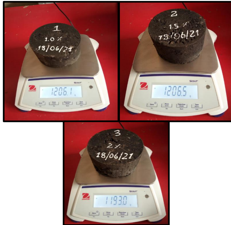
Figura 22. Muestras con adición de grano de caucho M-01, M-02 Y M-03
