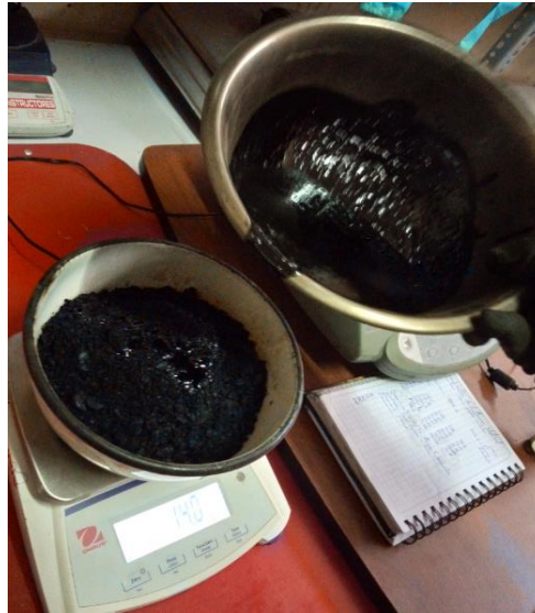
Figura 20. Mezclado del PEN y Material reciclado de llanta
