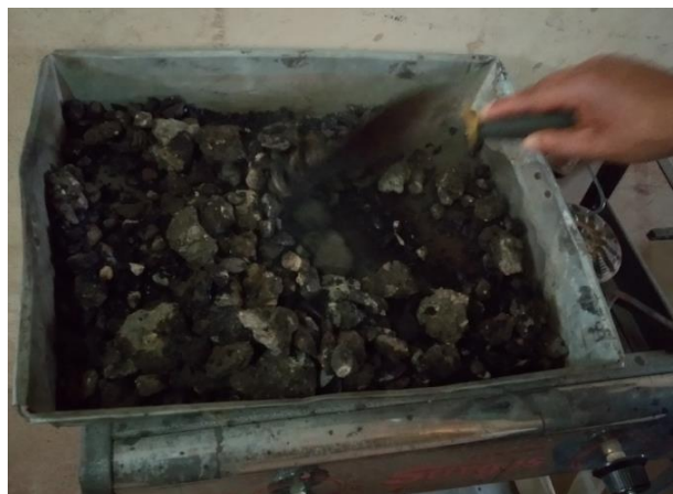
Figura 17 Revivido de la Muestra de Asfalto Reciclado
