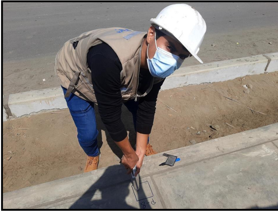
Imagen N°05, Usando el esclerómetro en el pavimento de vereda número 8.
