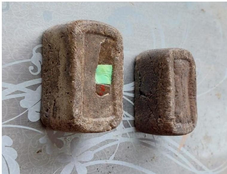
Foto 11. Producto final de los adoquines peatonales de poliestireno más escoria de cobre de la oroya.
