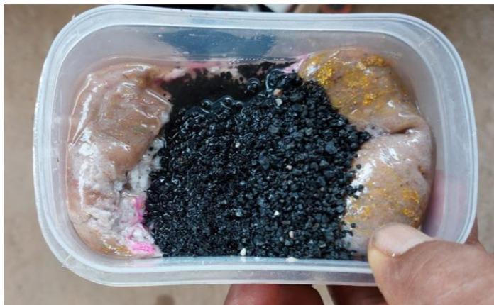
*Foto 5. Mezcla compuesta de poliestireno más escoria de cobre.*
