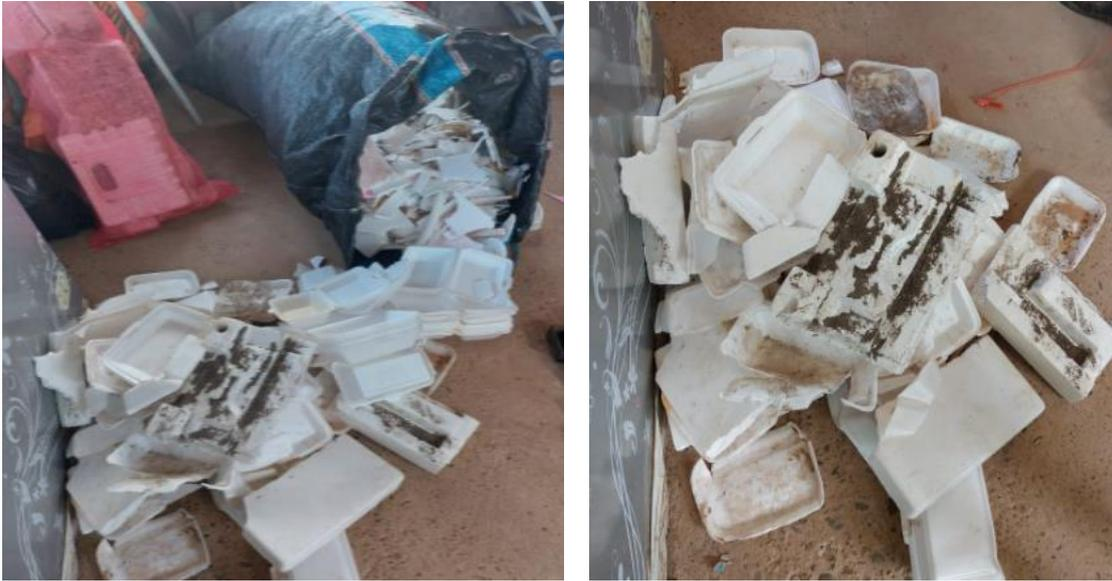
*Foto 1. Plástico poliestireno empleados para la obtención de los adoquines peatonales.*
