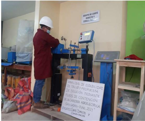
**Figura 39.** Corte directo para determinar: cohesión y ángulo de fricción interna del suelo
