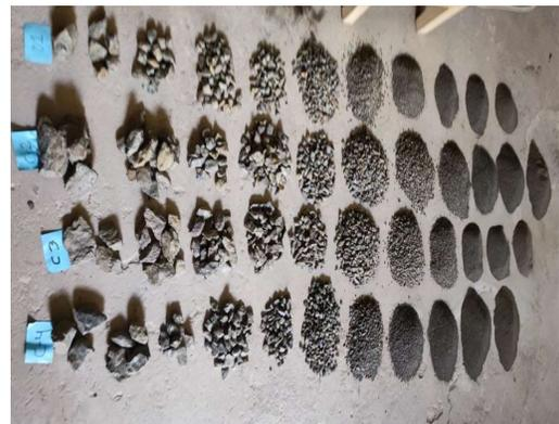
Fotografía 24: Ensayo de granulometría de las muestras.
