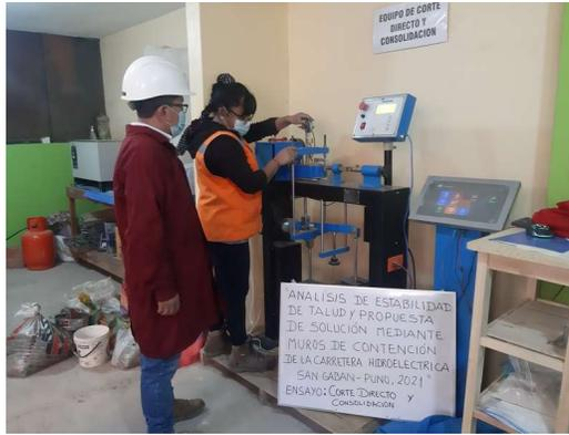
Fotografía 19: Ensayo de corte directo de las muestras.
