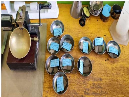
Fotografía 23: Preparado de las muestras para ensayo de límites.
