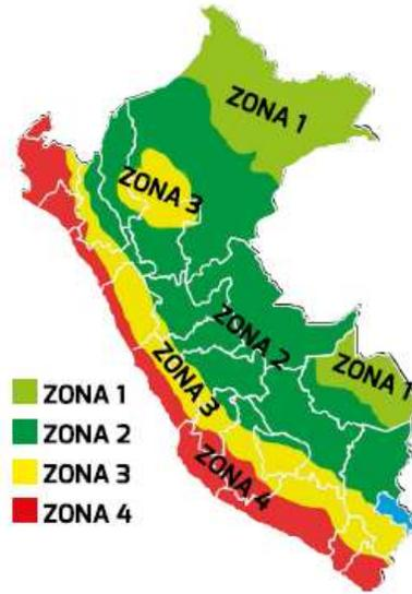
**Figura 2.** Zonificación sísmica
