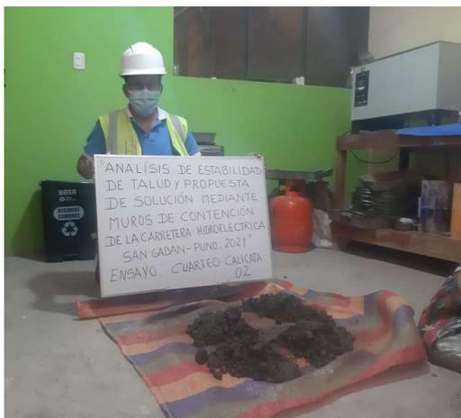
*Figura 35.* Cuarteo de la calicata 03, para determinar los parámetros físicos del suelo
