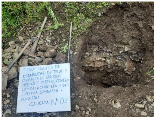
Fotografía 11: Perfil del suelo, roca fracturada a 1.50m en promedio.
