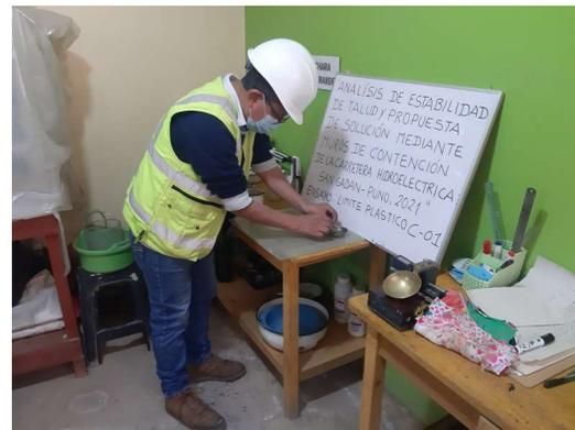
Fotografía 18: Ensayo de límites de consistencia de material fino.
