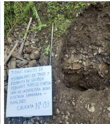
Figura 26. Presenta material de roca fracturada
