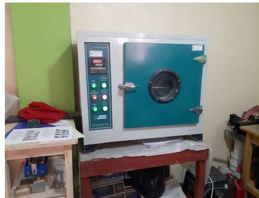
Fotografía 22: Secado de la muestra en horno.
