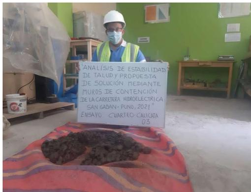
Fotografía 17: Cuarteo de muestra en laboratorio geotecnia Puno E.I.R.L.
