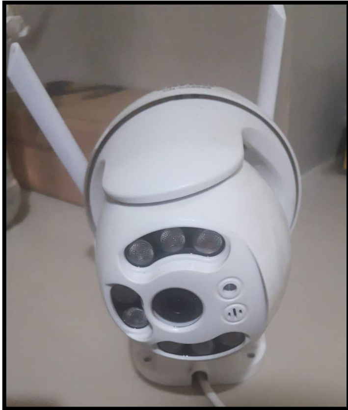
Figura 19. Cámara filmadora para conteo vehicular
