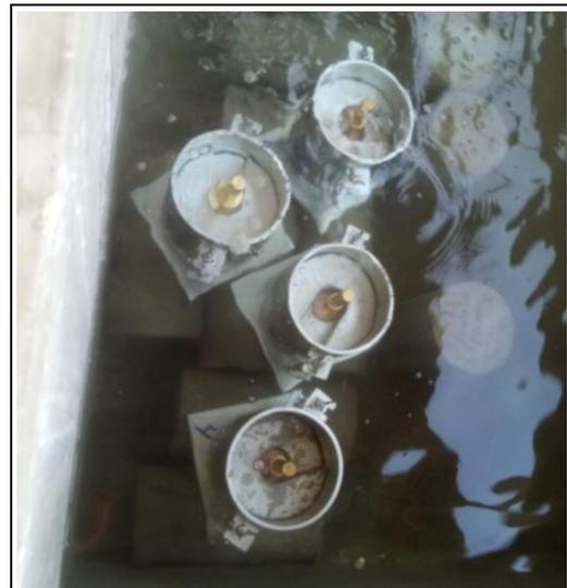
**FOTO N°22:** Muestras de CBR sumergidas a los cuatro días para medir su expansión.
