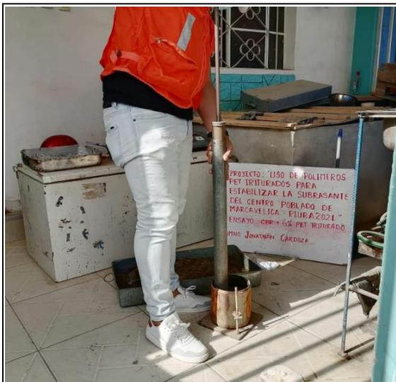
**FOTO N°19:** Ensayo del CBR a 56 golpes al incorporar el 6% de plástico PET Triturado.
