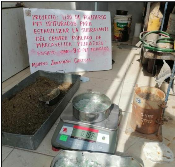
**FOTO N°21:** Incorporación del 9% de plástico PET Triturado para la realización del ensayo del CBR.
