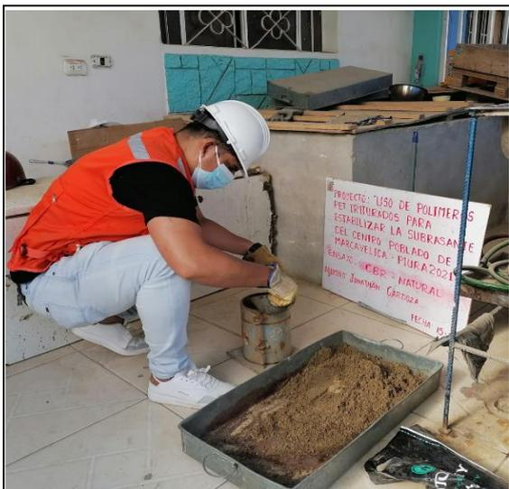
**FOTO N°15:** Ensayo de CBR del terreno natural de la Calicata C5.
