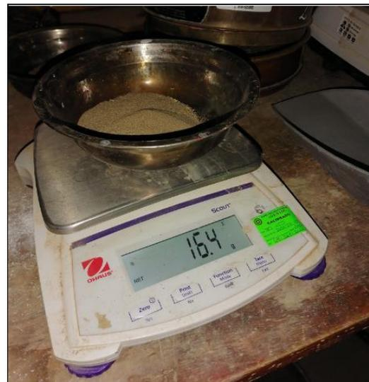
**FOTO N°12:** Peso de la muestra de Finos en seco, para el ensayo de límites de Atterbert.
