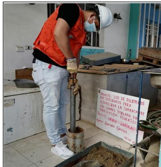
**FOTO N°16:** Ensayo de CBR del terreno natural de la Calicata C5.
