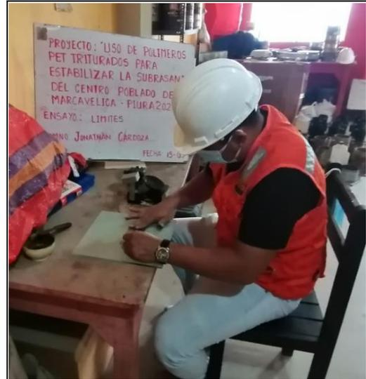
**FOTO N°14:** Ensayo de Limite Plástico.
