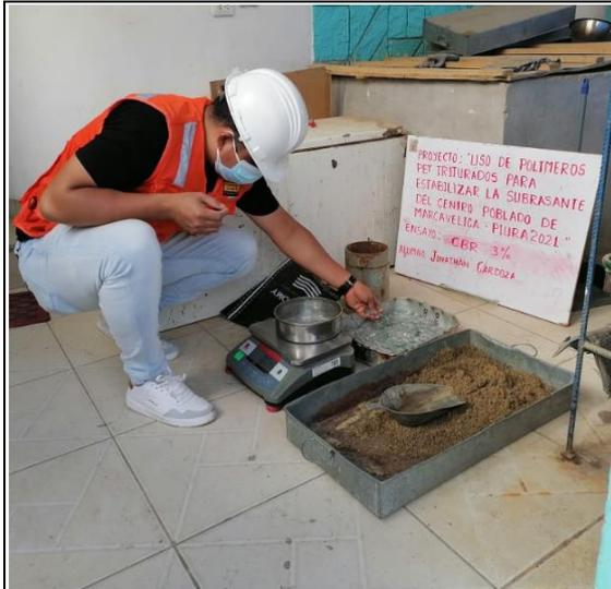
**FOTO N°17:** Pesado del 3% de plástico PET Triturado para la realización del ensayo del CBR.
