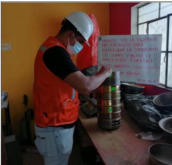
**FOTO N°11:** Ensayo de Granulometría de acuerdo a los lineamientos del manual de ensayos del MTC.
