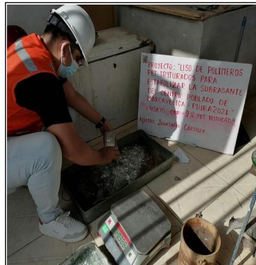
**FOTO N°20:** Incorporación del 6% de plástico PET Triturado para la realización del ensayo del CBR.
