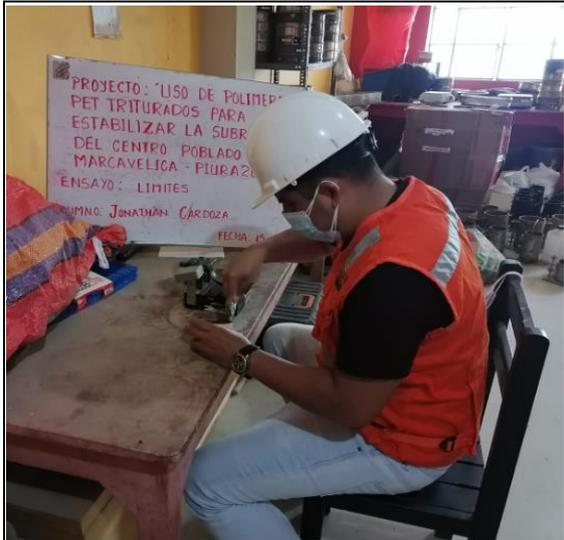
**FOTO N°13:** Ensayo de Limite Líquido.
