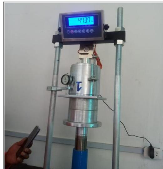
**FOTO N°24:** Ensayo de carga utilizando el pistón de la prensa de carga CBR a una Fuerza no menor de 45 KN.
