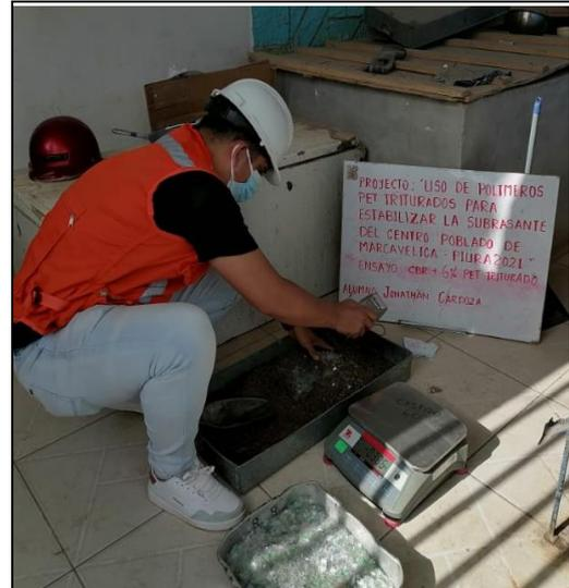
**FOTO N°18:** Incorporación del 3% de plástico PET Triturado para la realización del ensayo del CBR.
