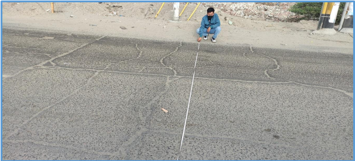
Figura 83. Medición del Ancho de la Calzada de las unidades de Muestra
