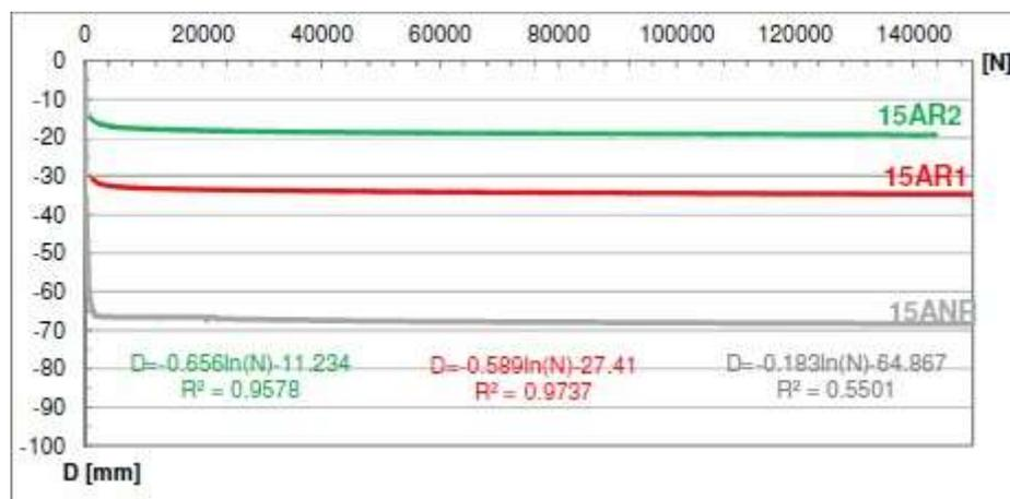
De la tesis se obtuvo la estructura con dos tipos de refuerzo (dos modelos de geomalla biaxial), la estructura con refuerzo n°1 presento un ahuellamiento de 35 mm, y en el caso de la estructura con refuerzo n°2 presento un ahuellamiento de 20 mm, observándose así una disminución a comparación con el modelo sin refuerzo, esta geomalla demuestra así una mayor exigencia mecánica según el tipo que se utilice y provocando una disminución en deformaciones en las capas granulares.
