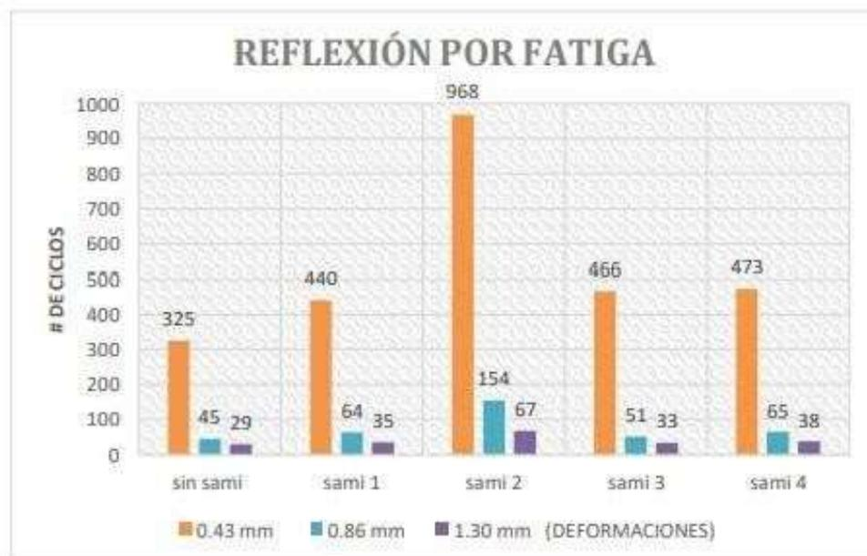
De la tesis se obtuvo que la geomalla de fibra de vidrio demostró que posee mayor capacidad de soporte ante las deformaciones a comparación de los otros geotextiles, viendo que ha soportado 968 ciclos generando así una deformación de 0.43cm mostrando ser mucho más eficiente al daño generado por fatiga.
