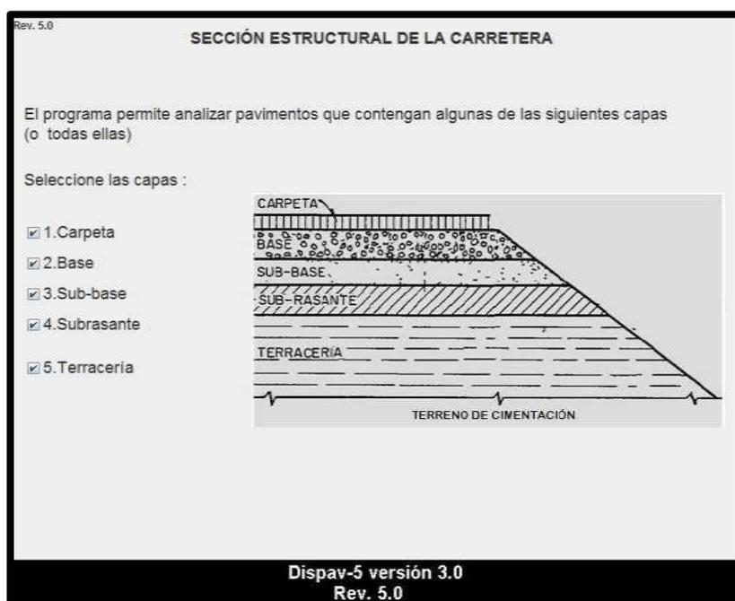
Figura N° 18 Sección estructural de la carretera
