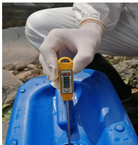
Figura 23. Medición de temperatura
