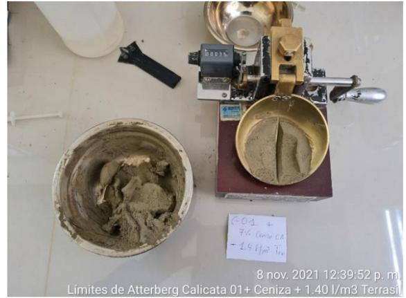
Figura 14. Límite Líquido con adición de 7% CCA y 1.40 lt/m<sup>3</sup> Aditivo Terrasil
