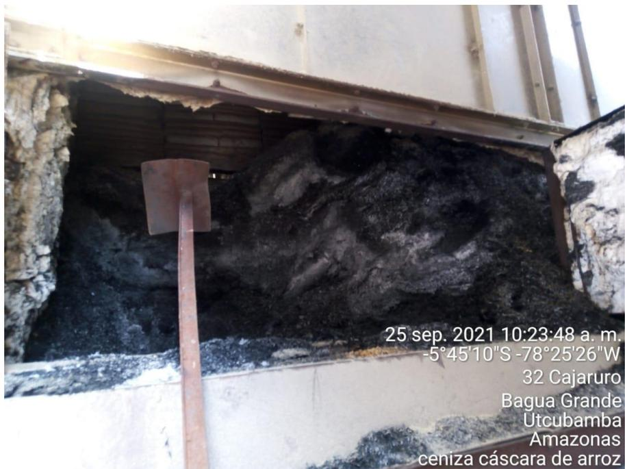
Figura 7. *Horno con ceniza de cascara de arroz. ceniza de cascara de arroz.*
