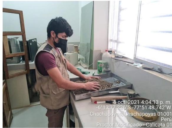
Foto 9. Mezcla de la calicata 01 para el Proctor en estado natural
