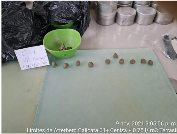
Figura 13. Límite Plástico con adición de 7% CCA y 0.75 lt/m<sup>3</sup> Aditivo Terrasil
