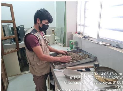
Figura 16. Material Para Proctor Modificado de la Calicata 01
