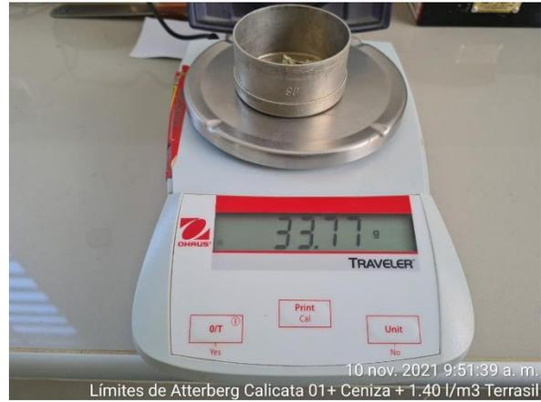
Foto 7. Pesado de la muestra para la dosificación del 1.4 lt/m3 del aditivo y 7% de la ceniza de cascara de arroz
