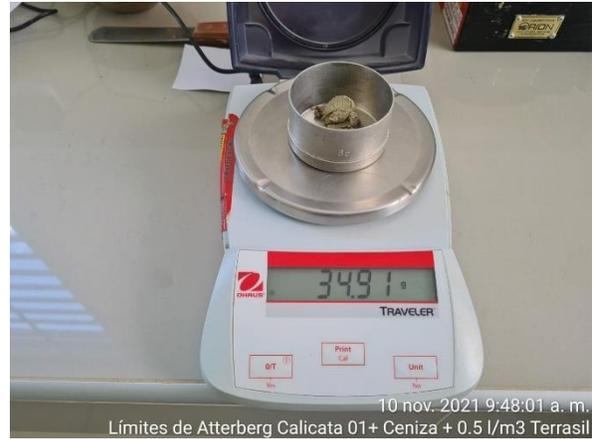
Foto 6. Pesado de la muestra para la dosificación del 0.5 lt/m3 del aditivo y 7% de la ceniza de cascara de arroz
