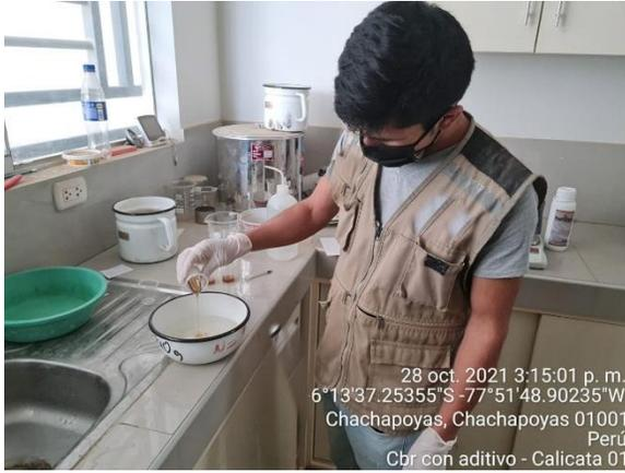
Foto 12. Mezclando el aditivo terrasil en agua para las dosificaciones.
