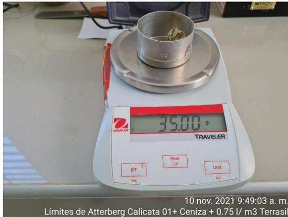
Foto 6. Pesado de la muestra para la dosificación del 0.75 lt/m3 del aditivo y 7% de la ceniza de cascara de arroz
