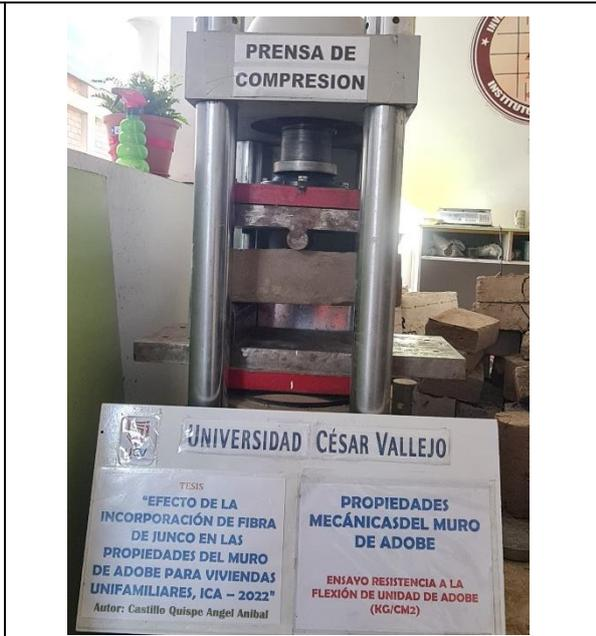
**Fotografía 10:** Ensayo de resistencia a la flexión
