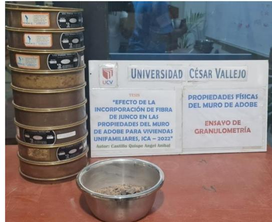
**Fotografía 06:** Ensayo de granulometría
