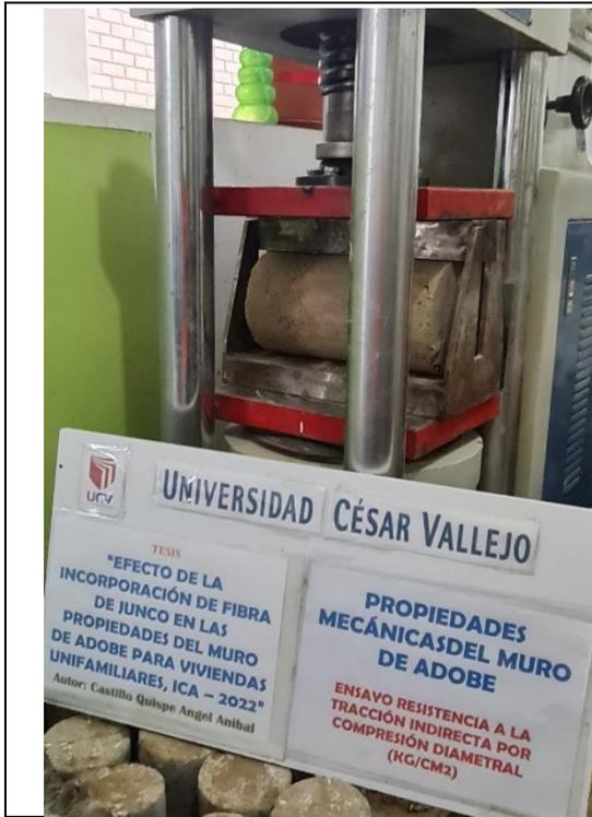
**Fotografía 13:** Resistencia a la tracción indirecta por compresión diametral
