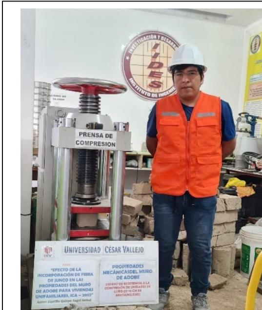
**Fotografía 09:** o de resistencia a la compresión de cubo de 10 cm de arista
