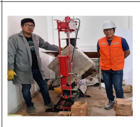
**Fotografía 16:** Ensayo de resistencia del muro a compresión diagonal
