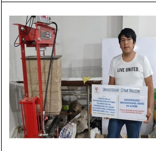
**Fotografía 15:** Ensayos de muere de tierra a compresión
