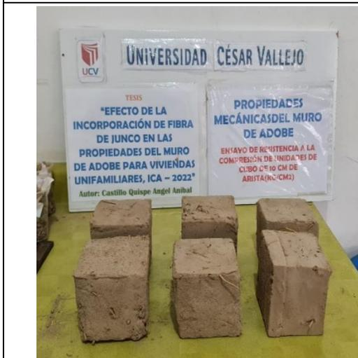
**Fotografía 11:** muestras ensayadas a compresión
