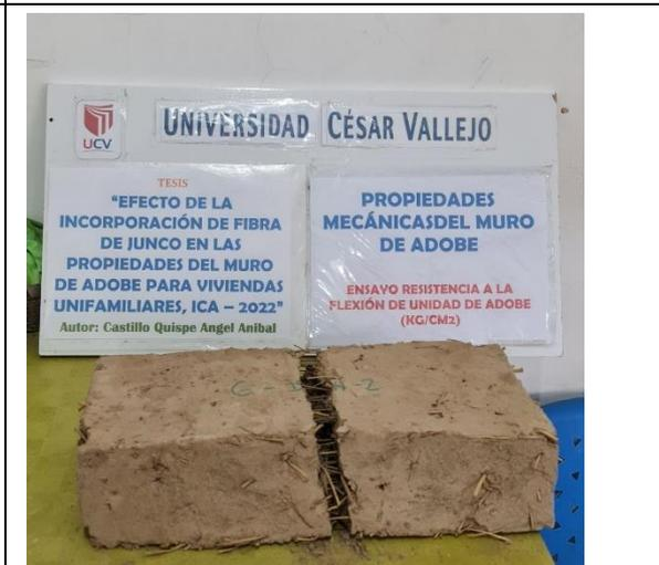
**Fotografía 12:** Muestra ensayada después del ensayo de Flexión
