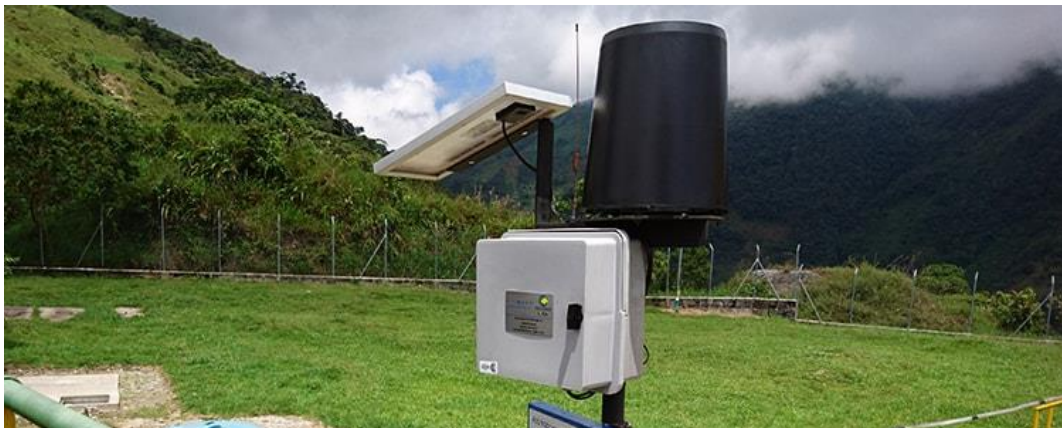
Figura N°25: El pluviógrafo automático.
