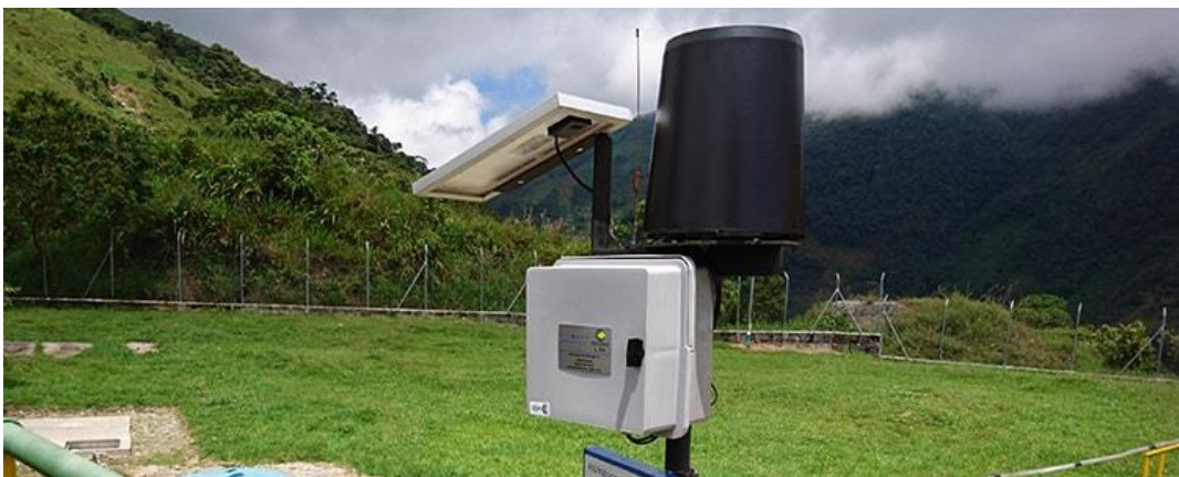
Figura N° 26. El Pluviógrafo automático.
