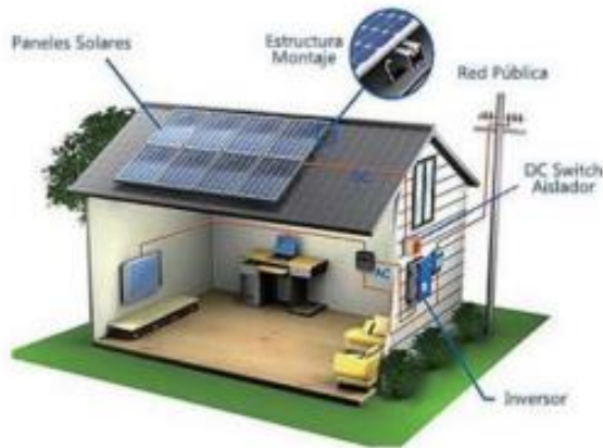
Figura 6 Esquema de sistema con conexión a la red eléctrica
