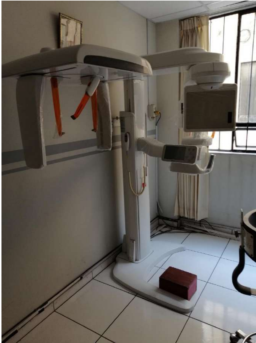
Figura 1. Equipo equipo panorámico Vatech modelo PHT-6500, tubo de rayos x tipo D-052SB/TOSHIBA.
