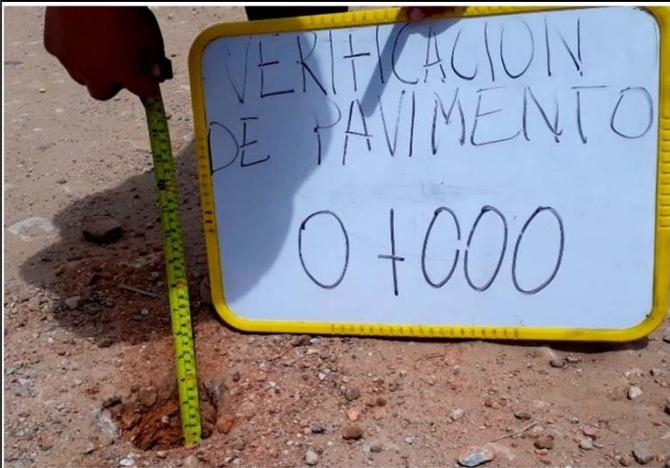
Foto N.º 03: Verificación de espesor de la superficie de rodadura de la carretera. Km 00+300.00
