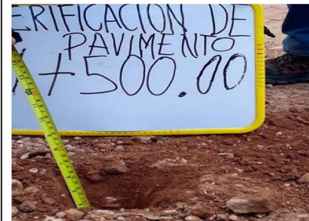
Foto N.º 09: Verificación del espesor de la superficie de rodadura de la carretera en la progresiva Km 01+500.00
