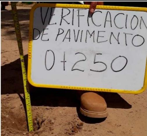
Foto N.º 05: Verificación de espesor de la superficie de rodadura en la progresiva km 00+480.00.
