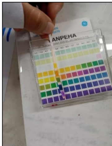
Figura 24. Medición de pH en la barra de labial
