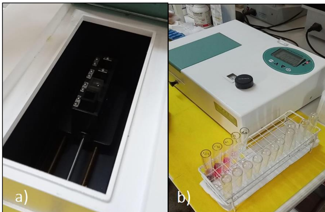
Figura 13. Espectrofotometría visible: a) celda de cuarzo, b) equipo espectrofotómetro
