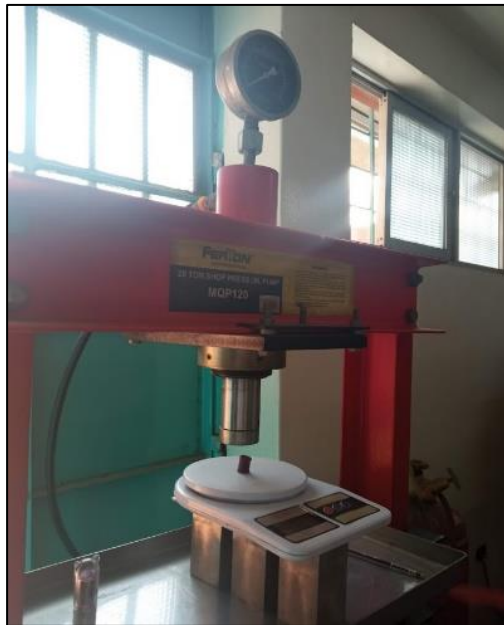
Figura 31. Deformación de la barra cosmética
