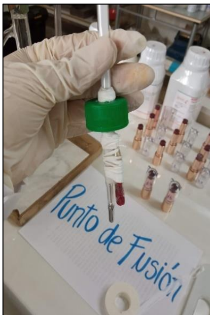
Figura 22. Punto de fusión de la muestra labial
