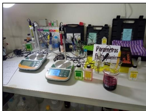
Figura 11. Calibración de electrodos mediante buffers
