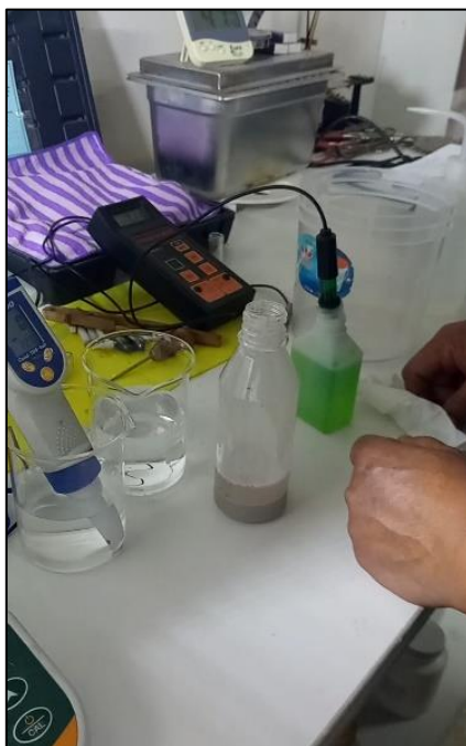
Figura 17. Calibración de sensores de electrodos
