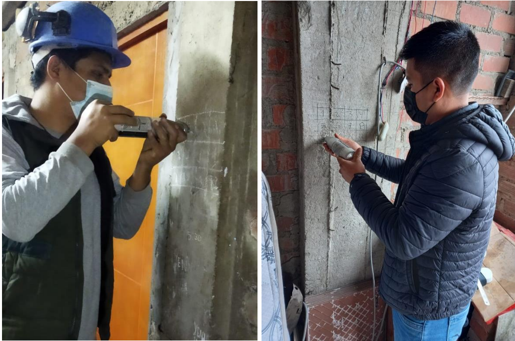
Figura 2. Ensayo de esclerómetro
