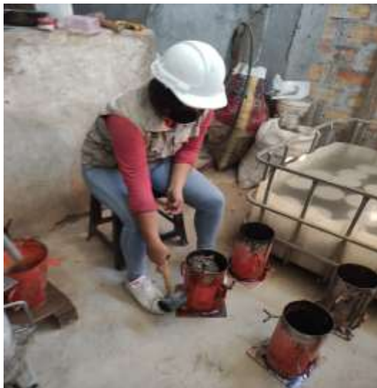
Figura N° 15-16: Personal realizando el moldeo de los testigos de concreto.
