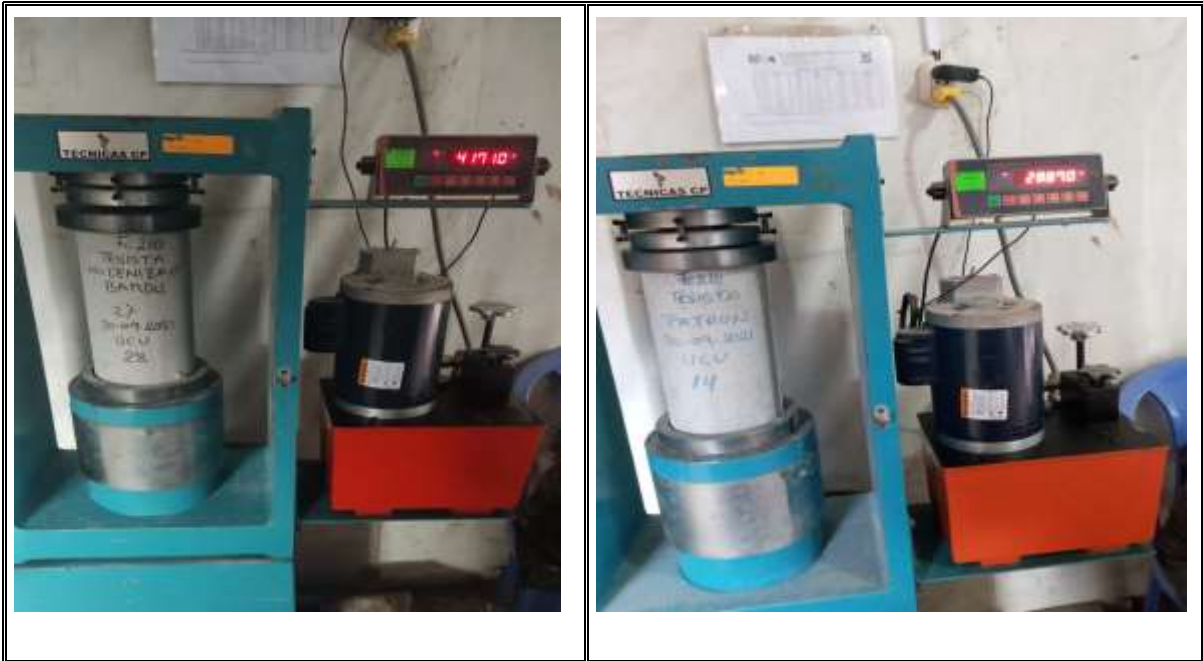
Figura N° 17-18: Resistencia a la compresión axial de los testigos de concreto 2% y patrón en 28 y 14 días respectivamente.
