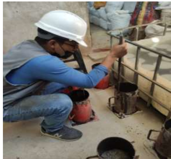
Figura N° 15-16: Personal realizando el moldeo de los testigos de concreto.
