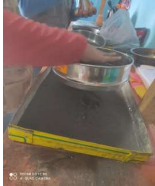
Figura N° 09-10: Tamizaje de la puzolana de la hoja de bambú para llevar a cabo los ensayos correspondientes.
