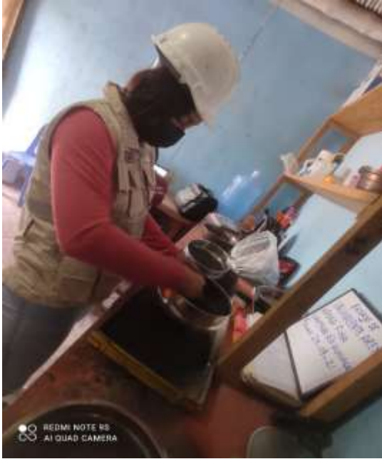
Figura N° 09-10: Tamizaje de la puzolana de la hoja de bambú para llevar a cabo los ensayos correspondientes.
