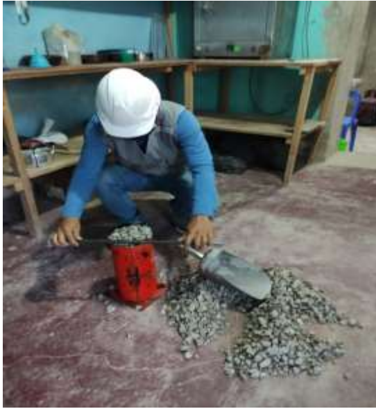
Figura N° 05-06: Realización del ensayo de peso unitario.
