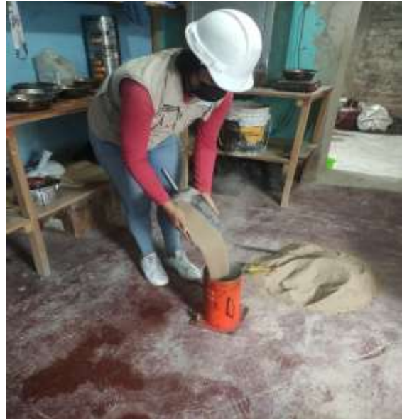
Figura N° 05-06: Realización del ensayo de peso unitario.
