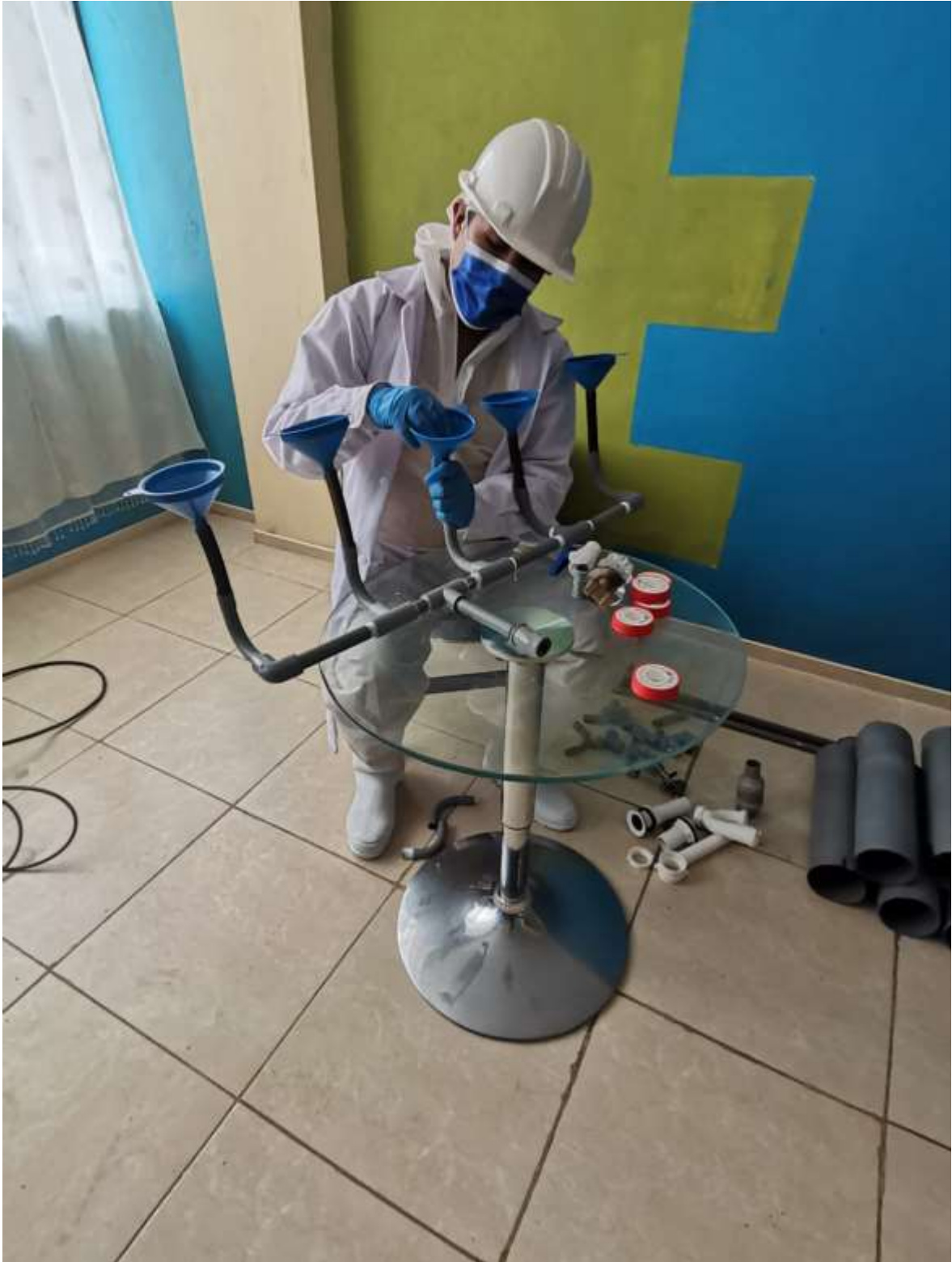
Figura 22. Proceso de armado del sistema de biofiltración.
