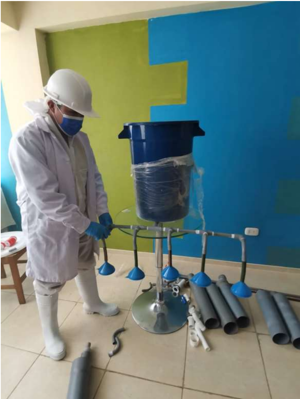
Figura 24. Conexión final del sistema de biofiltración.
