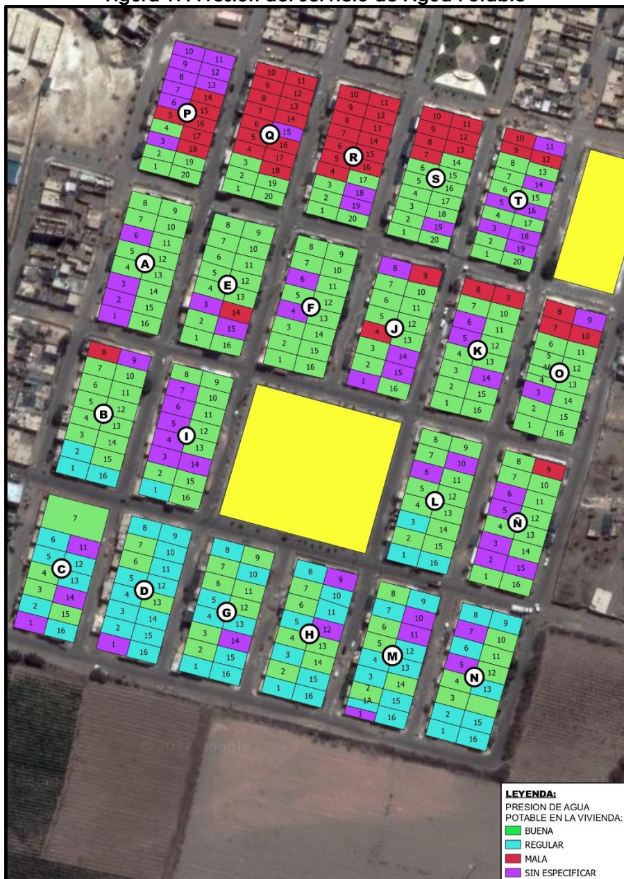
Figura 17: Presión del Servicio de Agua Potable
