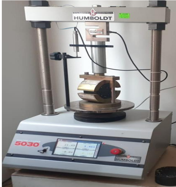
Figura 11. Briqueita en ensayo Marshall. Figura 12. Ruptura briqueita al 2%.
