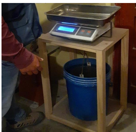
Figura 5. Aceite usado en proporción al peso de la mezcla asfáltica.
