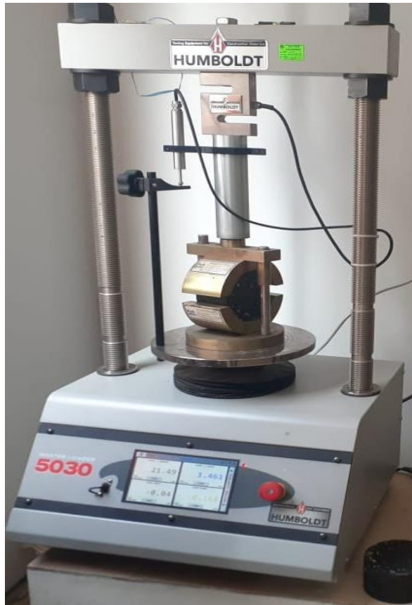
Foto 13. Rotura de briquetas.
