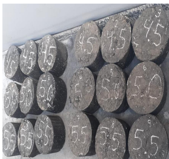
Figura 6. Briquetas con adicción de aceite usado al 0%, 2%, 4% y 6%.
