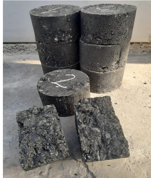
Figura 11. Briqueita en ensayo Marshall. Figura 12. Ruptura briqueita al 2%.
