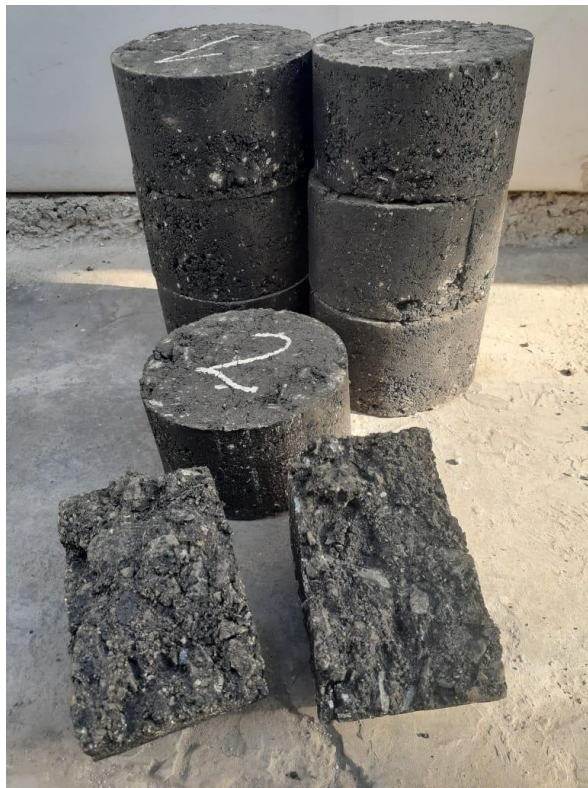
Foto 14. Rotura de briqueta.
