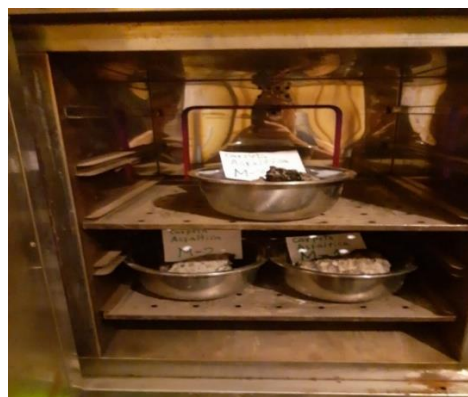
Figura 9. Mezcla asfáltica a temperatura de 145°C a 150°C.
